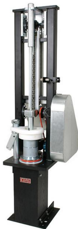
شکل ۴- چکش تراکم مکانیکی با دسته ثابت و پایه چرخان (نوع ۳)
