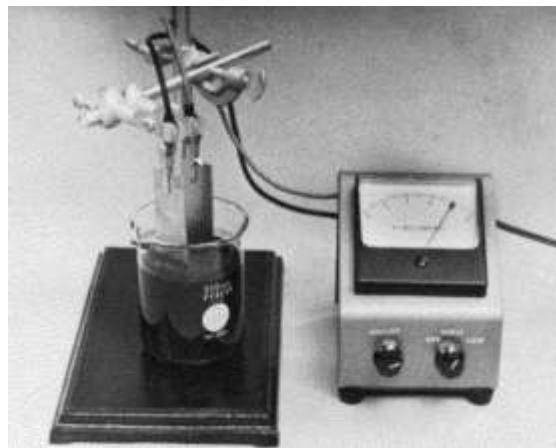
شکل ۱- دستگاه تعیین بار ذره
