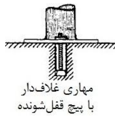
شکل الف ۱- انواع روش های مهار کردن نرده ها و نرده کشی فلزی به بتن و آجر
