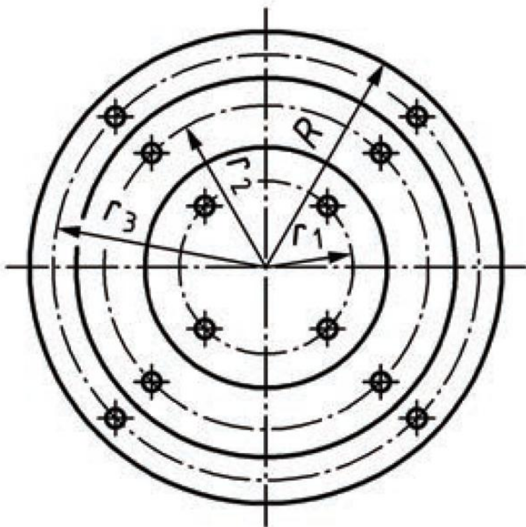
شکل ۲- نقاط اندازه‌گیری سرعت هوا در کانال استوانه‌ای معادله (۵) و شرایط فوق‌الذکر برای استفاده، در جدول ۱، مرتب شده‌اند.
