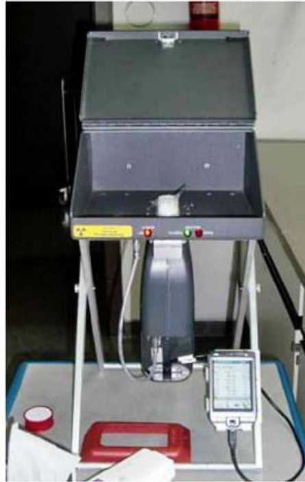
شکل الف-۴- دستگاه XRF دستی نصب شده بر روی یک پایه با استفاده از فنجان‌های پر شده با نمونه و پوشش حفاظتی تابش
