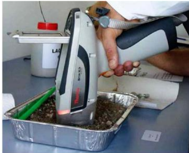
شکل الف-۱- اندازه‌گیری مستقیم با استفاده از دستگاه XRF دستی
