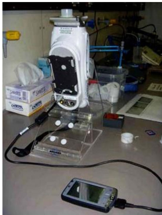
شکل الف-۳- دستگاه XRF دستی نصب شده بر روی یک پایه با استفاده از فنجان‌های پر شده با نمونه
