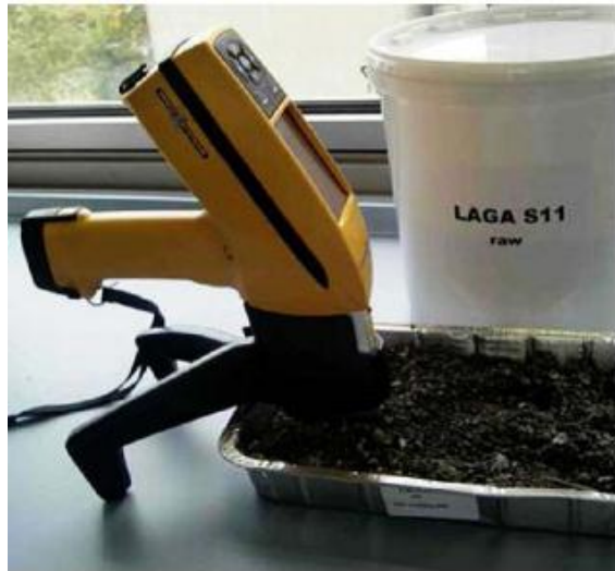
شکل الف-۲- اندازه‌گیری مستقیم با استفاده از دستگاه XRF دستی نصب شده بر روی پایه
