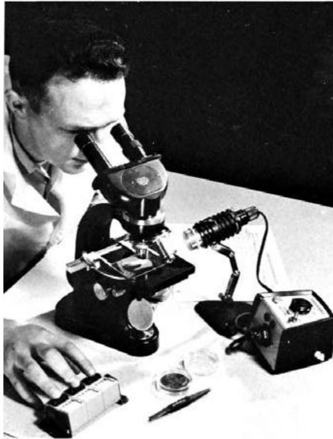
شکل ۱- میکروسکوپ مناسب: بدنه دوچشمی شیب‌دار؛ صفحه مکانیکی، با قسمت تحتانی سه‌گانه؛ ترکیب عدسی چشمی-شیئی برای ایجاد بزرگ‌نمایی 40\times تا 45\times و 90\times تا 150\times
