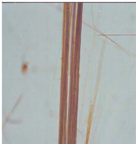
شکل ت ۱۰- آموسیت گرم شده در مایع با 1/680\text{RI} مشاهده شده در صفحه نور قطبنده- طول فیبر در جهت نرمال با نوسان قطبنده
