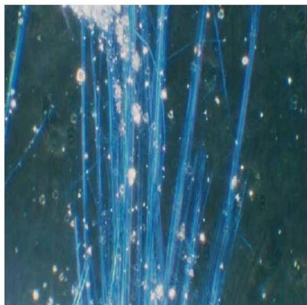
شکل ت ۱۶- SRM ۱۸۶۶ کروسیدولیت در مایع با ۱/۷۰۰ RI پراکندگی لکه - طول فیبرها در جهت نرمال با نوسان قطبنده
