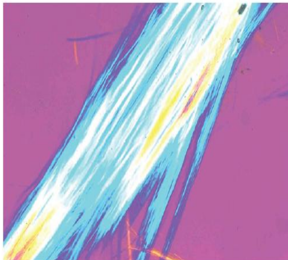
شکل ت ۴۹- ریز نگار PLM از HSE آزیست ریجتریت/وینچیت در مایع با RI ۱/۶۳۰ - قطب‌های متقاطع با صفحه تاخیر ۵۳۰nm
