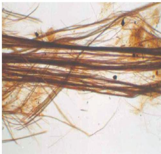
شکل ت ۱۷- کروسیدولیت گرم شده مشاهده شده در صفحه نور قطبنده- طول فیبر در جهت موازی با نوسان قطبنده
