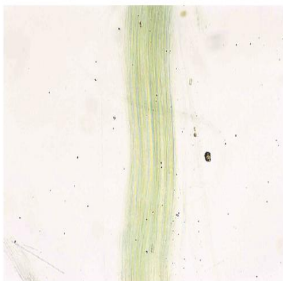
شکل ت ۴۴- HSE اکتینولیت در مایع با RI ۱/۶۴۰ مشاهده شده در نور صفحه قطبنده- طول فیبر نرمال با جهت نوسان قطبنده
