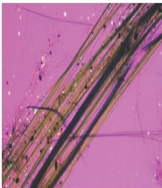
شکل ت ۱۱- ریز نگار PLM از SRM ۱۸۶۶ کروسیدولیت در مایع با 1/700\text{RI} - قطب‌های متقاطع با صفحه تاخیر 530\text{nm}
