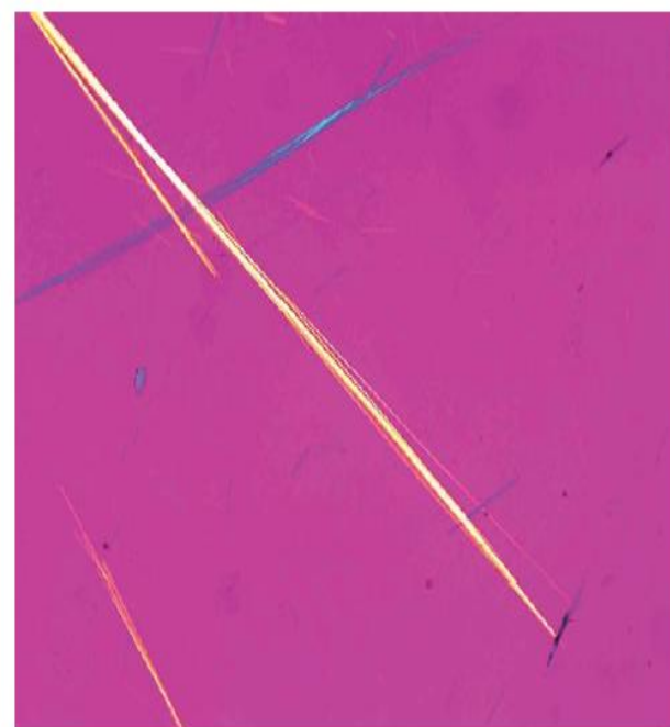
شکل ت ۲۸- ریز نگار PLM از SRM ۱۸۶۷ اکتینولیت در مایع با RI ۱/۶۳۰ - قطب‌های متقاطع با صفحه تاخیر ۵۳۰nm
