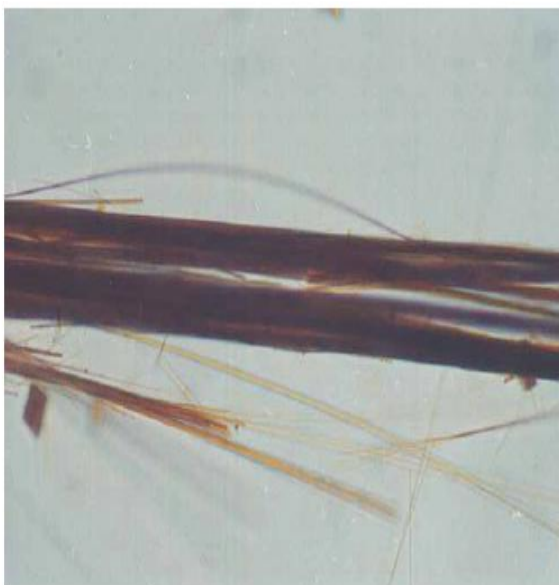
شکل ت ۹- آموسیت گرم شده در 1/680\text{PI} مایع مشاهده شده در صفحه نور قطبنده- طول فیبر در جهت موازی با نوسان قطبنده
