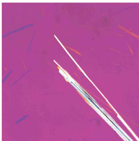
شکل ت ۲۰- ریز نگار PLM از SRM ۱۸۶۷ تریمولیت در مایع با ۱/۶۰۵RI - قطب‌های متقاطع با صفحه تاخیر ۵۳۰nm
