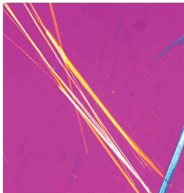
شکل ت ۲۴- ریز نگار PLM از SRM ۱۸۶۷ تریمولیت در مایع با 1/62\Delta RI - قطب‌های متقاطع با صفحه تاخیر 530\text{nm}
