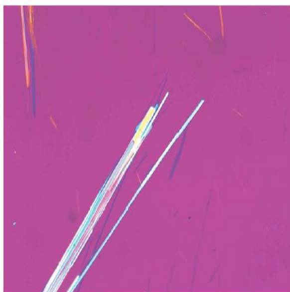
شکل ت ۱۹- ریز نگار PLM از SRM ۱۸۶۷ تریمولیت در مایع با ۱/۶۰۵RI - قطب‌های متقاطع با صفحه تاخیر ۵۳۰nm
