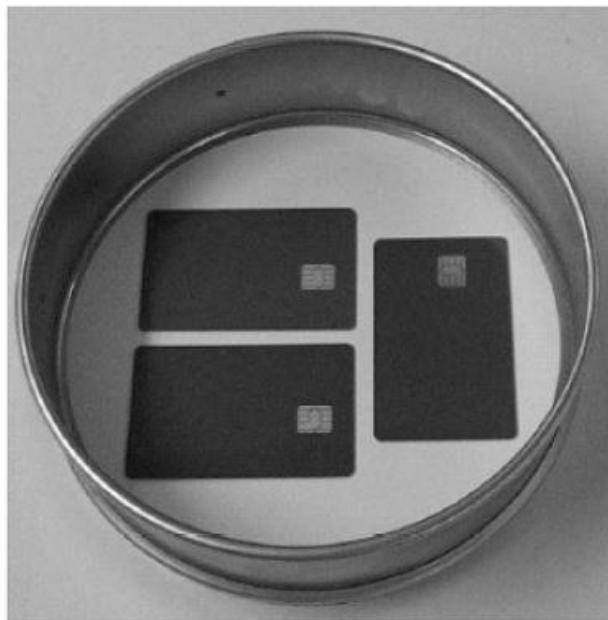
شکل ۵- نمایش موقعیت کارت‌ها و ورق در الک
