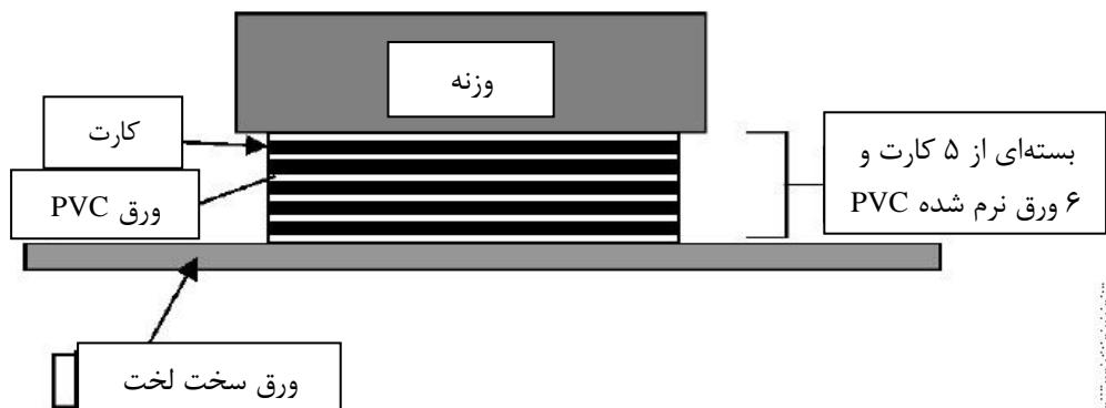
شکل ۴- کارت‌های بسته شده برای استفاده در محفظه محیطی
