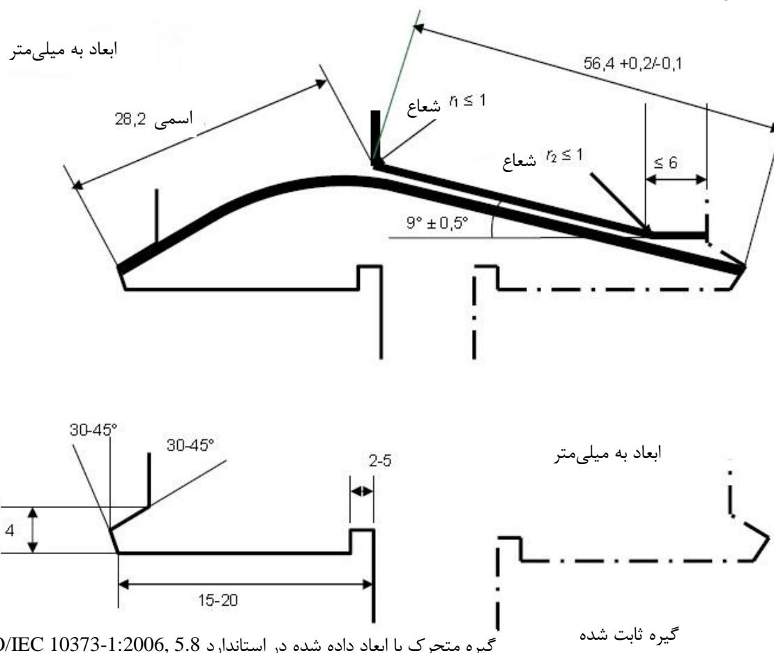
شکل الف-۱- بش عرضی بلوک بالابرند و نمایش بالا بردن کارت
