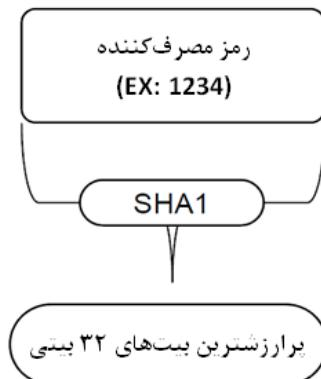
شکل ۴- تولید اسم رمز دسترسی با استفاده از فقط ورودی مصرف‌کننده
