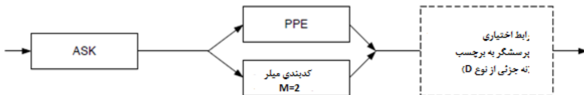
شکل ۳-معماری پرسشگر نوع C
