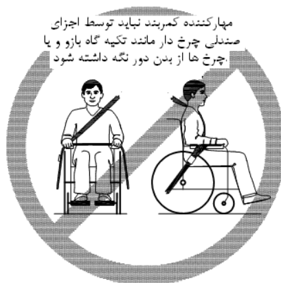
شکل ث-۲ مثالی از تصویرعلائم هشداردهنده نصب نامناسب کمر بند محافظ سرنشین
