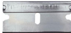
شکل الف ۲- تیغ تک لبه برای صیقلی کردن لبه و سطح فاق
