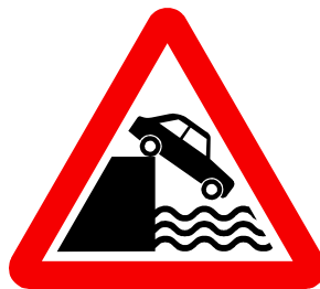
شکل ۳-۴۵ - خطر سقوط در آب
