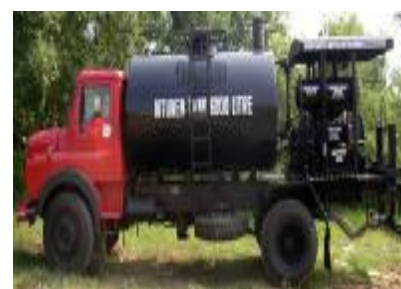
شکل ۱۲- ماشین قیرپاش و آب پاش - روسازی راه
