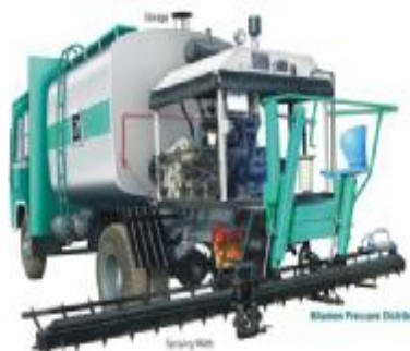
شکل ۱۲- ماشین قیرپاش و آب پاش - روسازی راه
