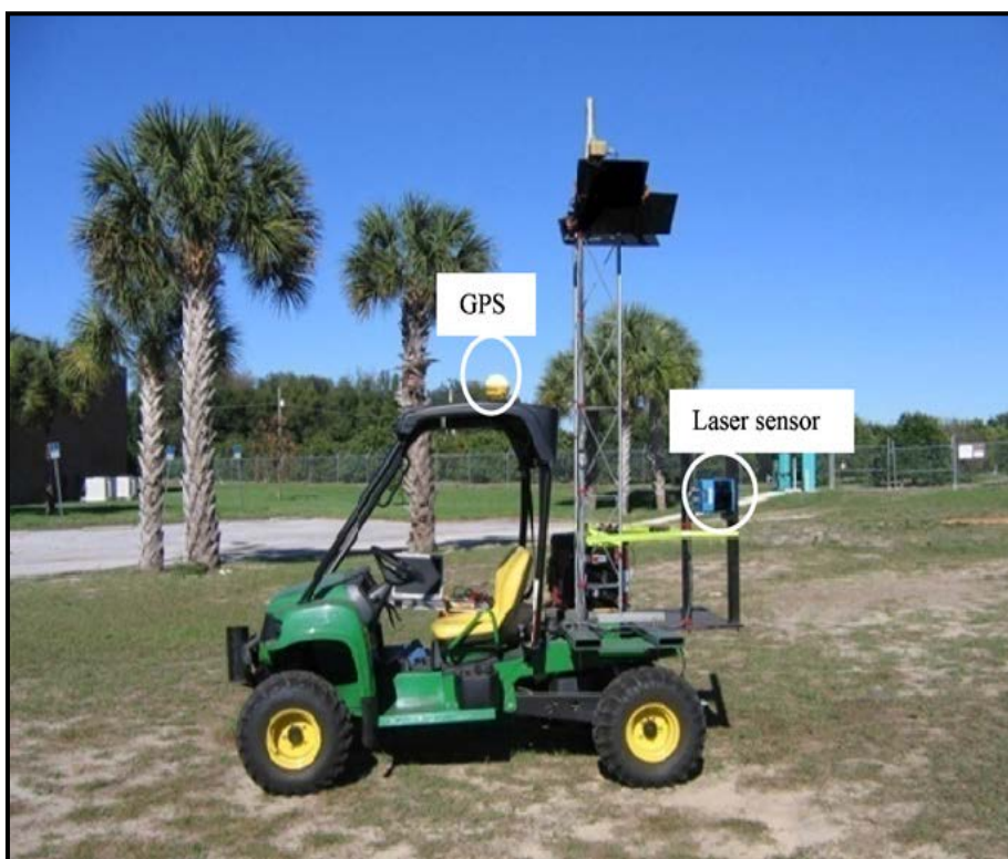
عکس ۱-۲- وسیله نقلیه مجهز به وسایل اندازه‌گیری سیستم اسکن لیزری
