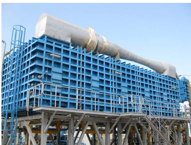
شکل ۴-۲۲- آب شیرین کن MED در پروژه شماره ۷
