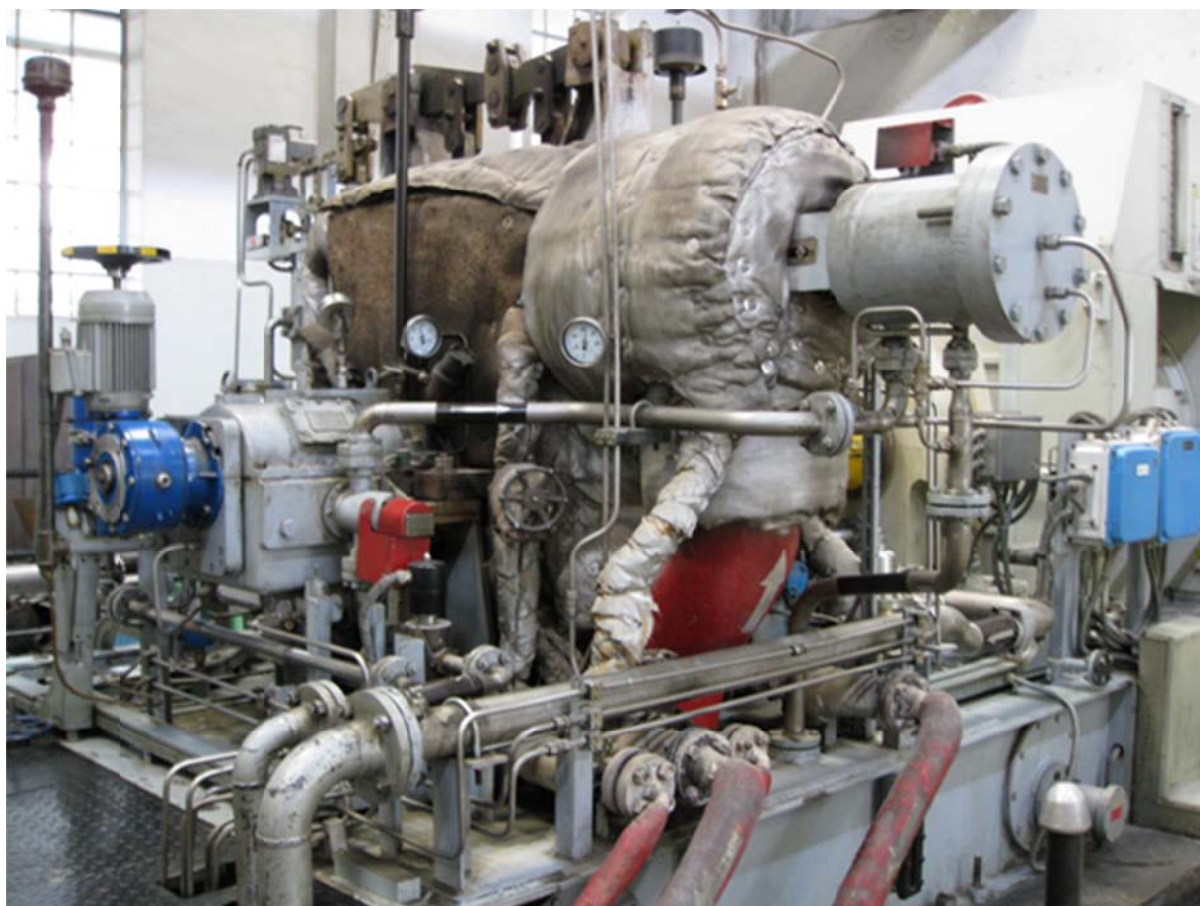
شکل ۱-۴- توربین بخار پس فشاری
