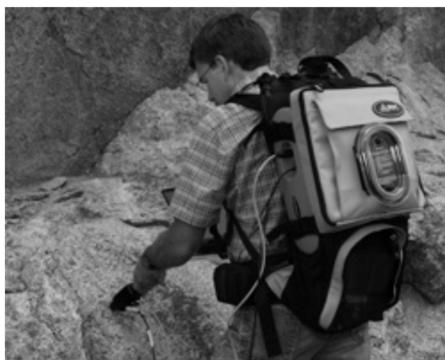
شکل ۶-۲- نمونه‌ای از یک دستگاه طیف‌سنج قابل حمل زمینی در حال اندازه‌گیری طیف یک رخنمون سنگی
