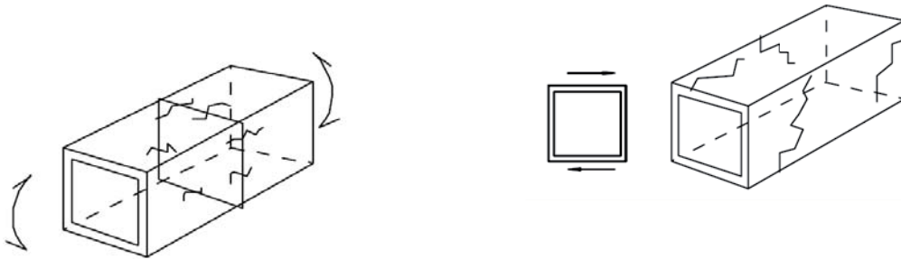
(۱) ترک‌های ناشی از تغییر شکل بیخشی در امتداد طولی
