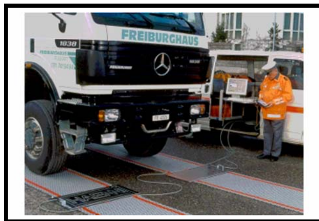
شکل ۲-۲۴- نمونه ای از صفحات خازنی متصل به تحلیل گر
