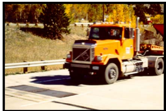
شکل ۲-۲۳- سیستم توزین در حرکت سلول بار
