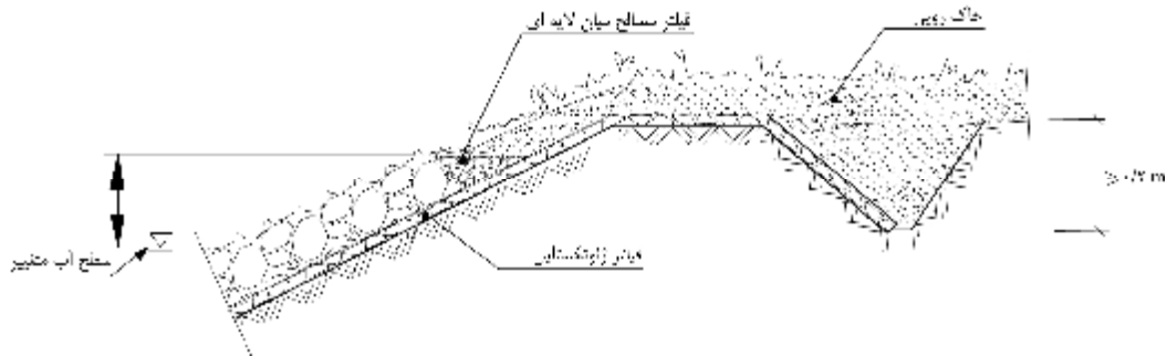
شکل پ-۳-۹- لبه‌ی بالایی فیلتر در حالت دبی شدید آب‌های سطحی
