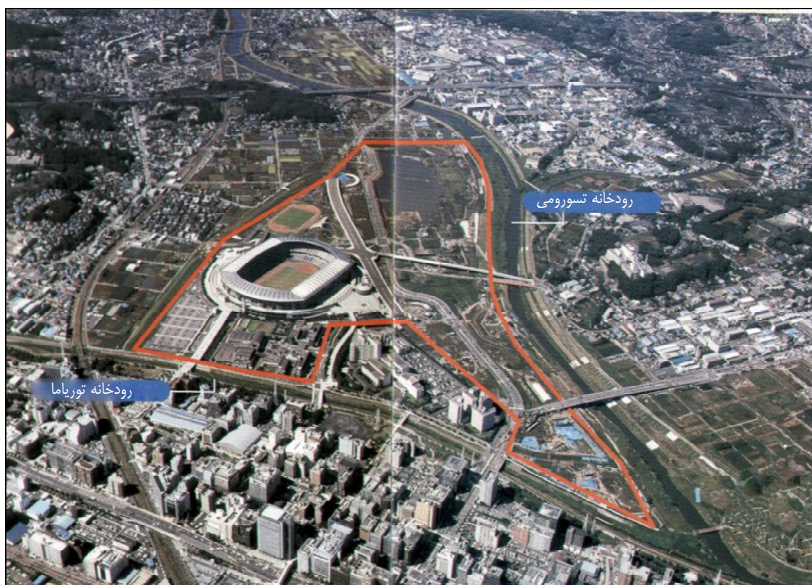
شکل ۲-۶ - نقشه پلان و تصویر استخر تاخیری در مجاورت رودخانه تسرومی در کشور ژاپن [۹]
