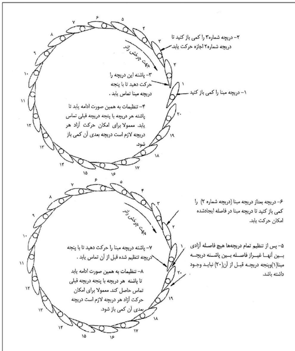
شکل پ.۵-۲- دستورالعمل میزان کردن دریچه‌های تنظیمی نوع الف
