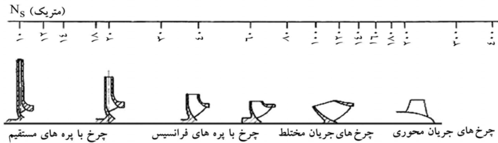
شکل ۲-۵- رابطه پروفیل چرخ با سرعت مخصوص
