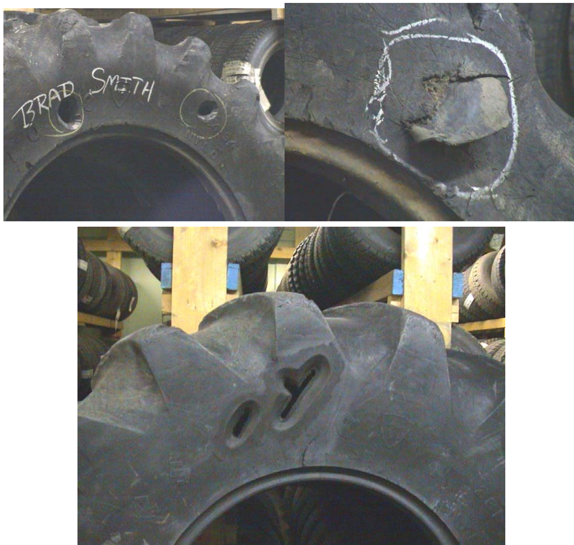
شکل شماره (۵-۱۰) - نمونه هایی از آسیبهای وارده بر دیواره کناری لاستیکها
