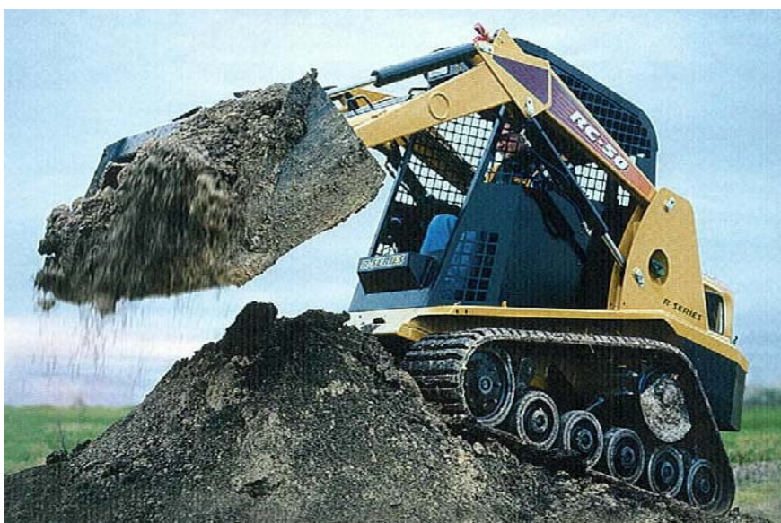
شکل شماره ۴-۵۶- نمایی از یک ماشین عمرانی با شاسی رولیک (چرخهای زنجیری)
