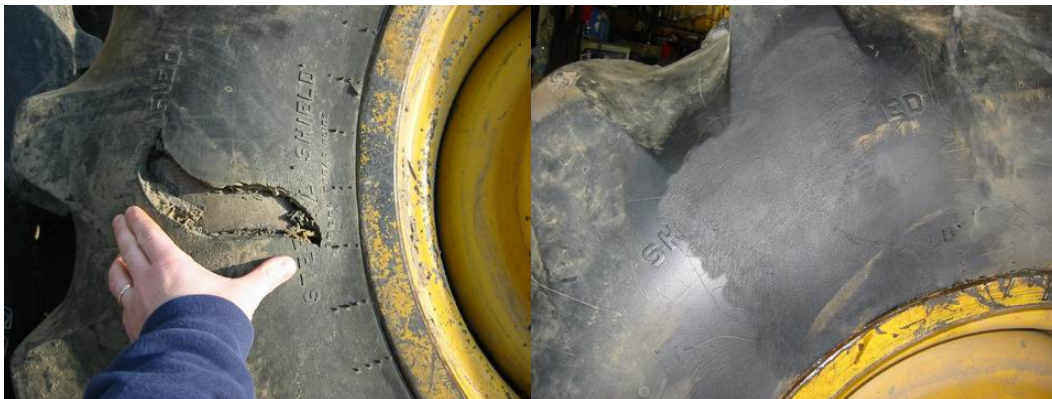
شکل شماره (۵-۹)- در تصویر سمت چپ یک نمونه پارگی دیواره کناری لاستیک نشان داده شده است. تصویر سمت راست وضعیت لاستیک را بعد از تعمیر آن نشان می‌دهد.
