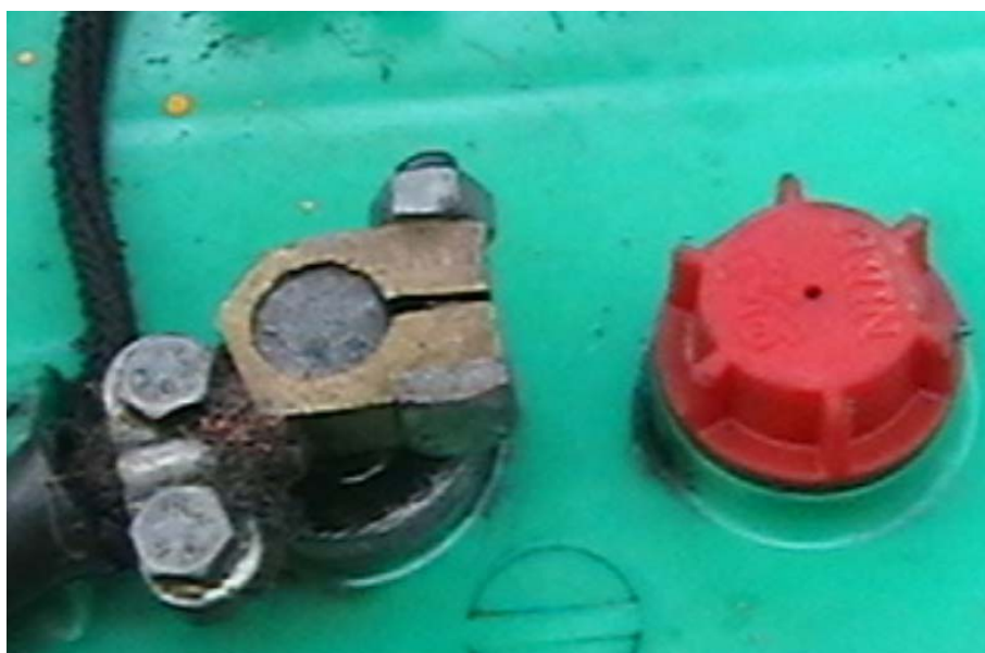
شکل شماره (۴-۱۰) ناحیه نیازمند گریسکاری (ناحیه دور قطب و بست که لازمست مورد گریسکاری قرار گیرد) ب - ردیابی و اندازه گیری فرسایش و میزان خرابی:
