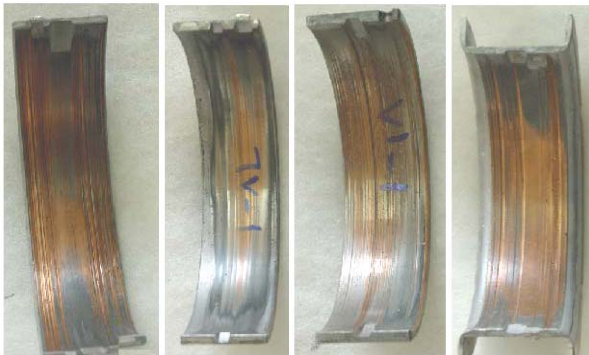
شکل شماره (۷-۶) - سایش یاتاقان ناشی از گردوغبار
