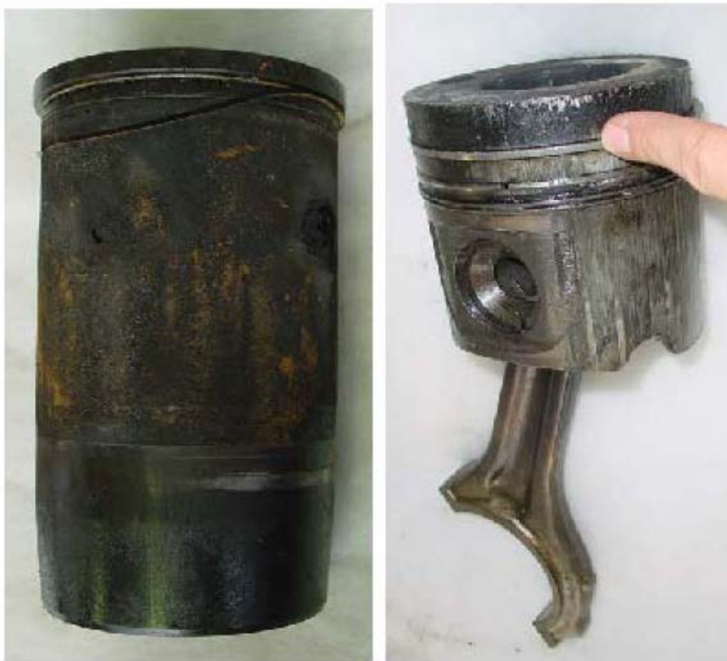
شکل شماره (۶-۶) - سایش رینگ، پیستون و بوش پیستون ناشی از گرد و غبار
