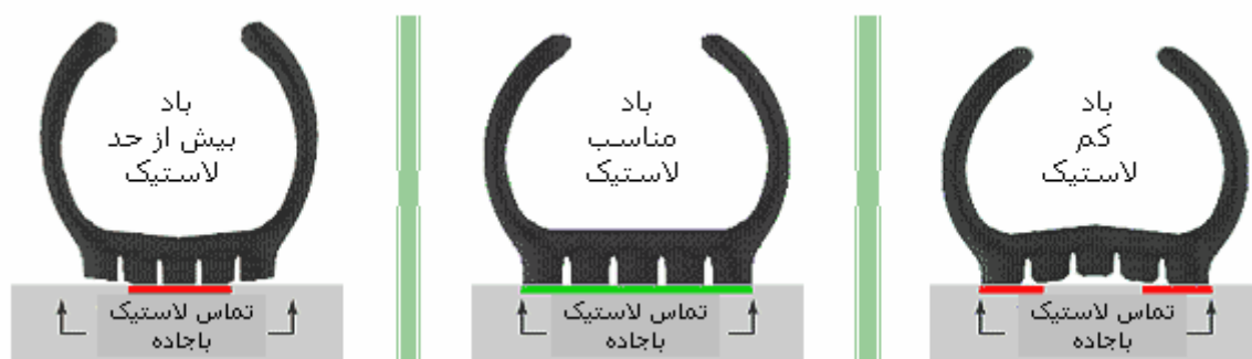
شکل شماره (۵-۷) - تاثیر کم بادی و پربادی بر سطح تماس لاستیکها با جاده
