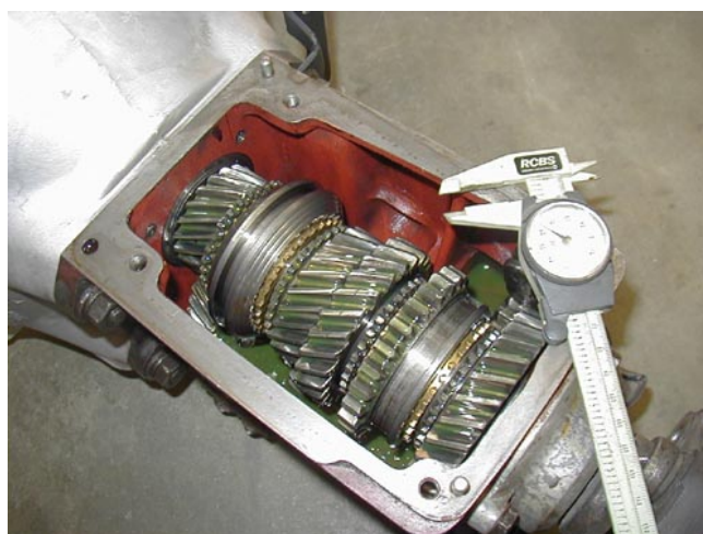
شکل شماره (۴-۳۶) - نمایی از یک گیربکس (کنترل دوره ای میزان روغن گیربکسها از اهمیت بالایی برخوردار می‌باشد)
