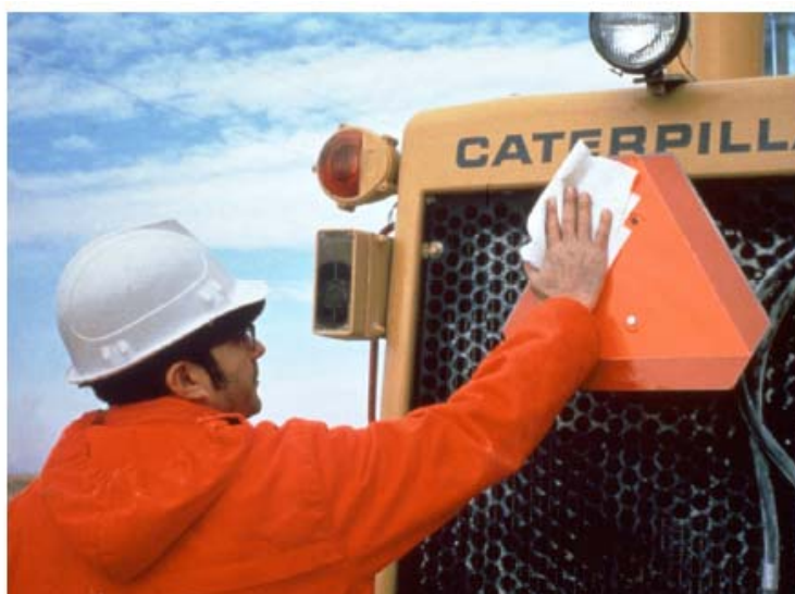
شکل شماره (۴-۶) - نظافت بدنه ماشین برای افزایش عمر مفید آن و حفظ رنگ بدنه بسیار حیاتی می‌باشد
