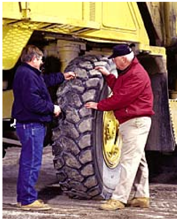
شکل شماره (۵-۱۱)- اجرای بازرسی روزانه برای اطمینان از سالم بودن و وضعیت مناسب لاستیکها.
