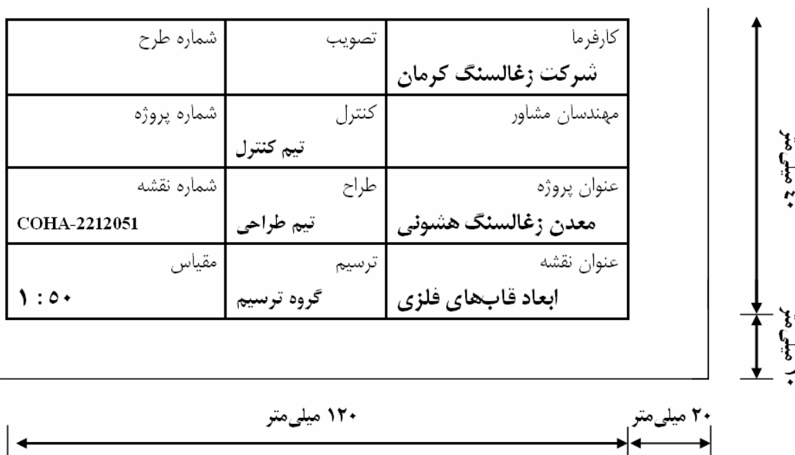
شکل ۵-۵- نمونه جدول عنوان نقشه برای کاغذ A 4 به صورت فارسی
