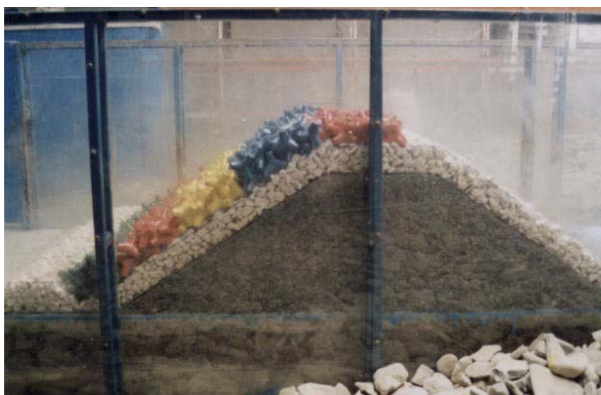
شکل ۶-۱۱ مقطع عرضی مدل فیزیکی یک موج‌شکن توده سنگی مسلح له آرمورهای تتراید در فلوم موج
