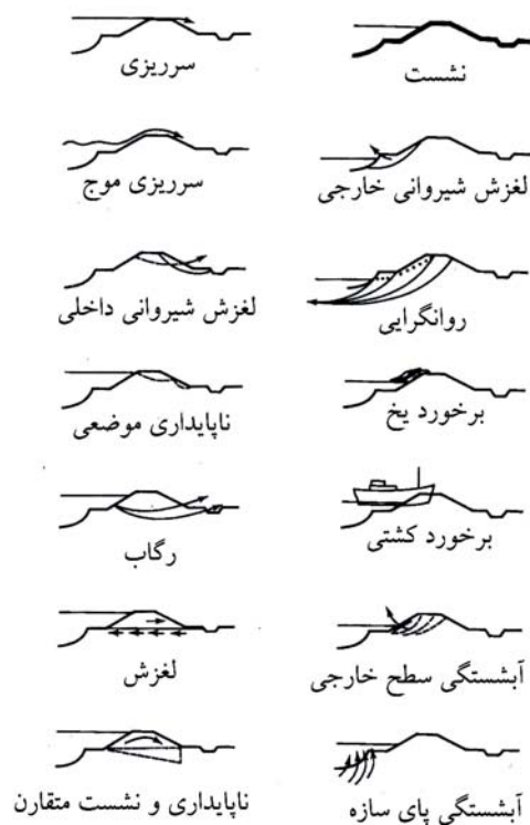
شکل ۵-۶ مکانیزمهای تخریب یک سد دریایی
