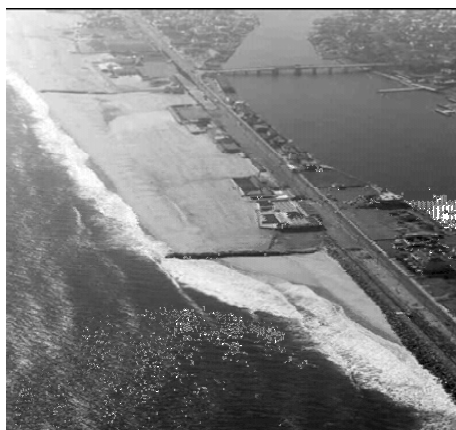
شکل ۱۸-۲ تغذیه مصنوعی ساحل به وسیله پمپاژ مواد لایروبی شده در ساحل
