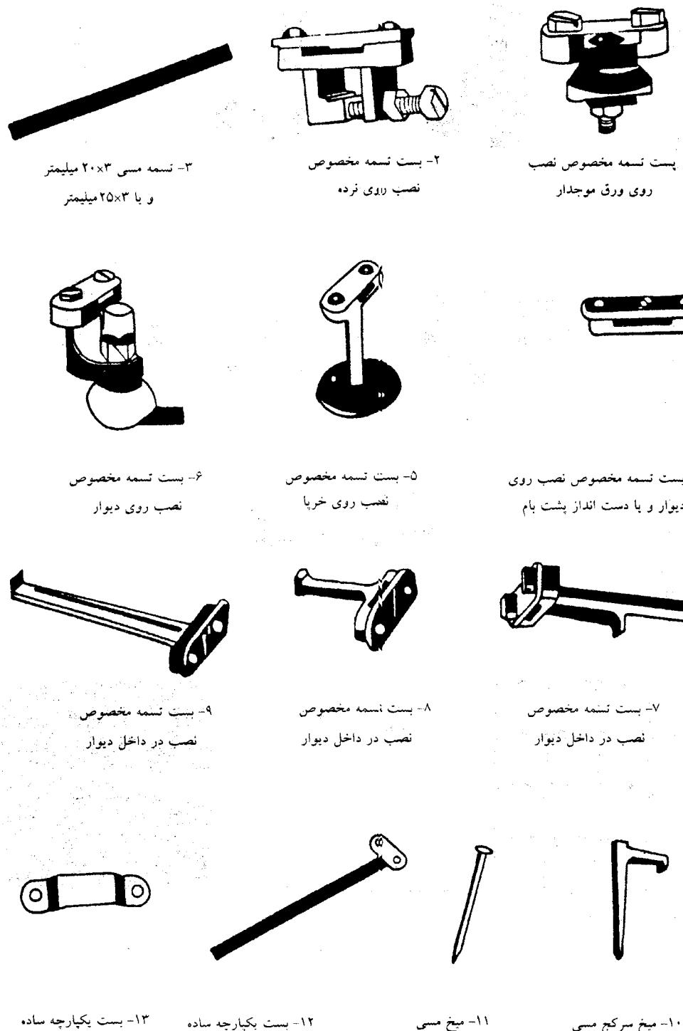
شکل ۱۹ : بستهها و نگهدارندهای مختلف تسمه
