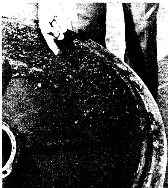
شکل ۱-۱۰ تجمع کثافات و گریس در نتیجه گریسکاری بیش از اندازه
