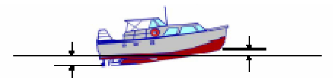
شکل ۲-۲- اثر بالا آمدگی جلوی شناور ناشی از سرعت (Squat)
