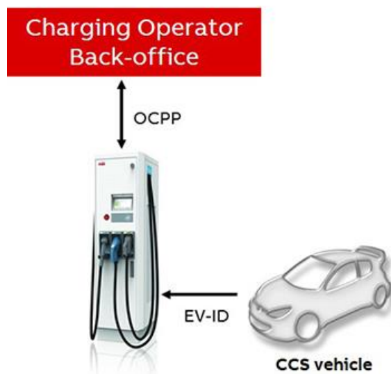
شکل ۴-۱۶: ارتباط میان خودرو الکتریکی، ایستگاه عمومی شارژ و بک آفیس از طریق OCPP
