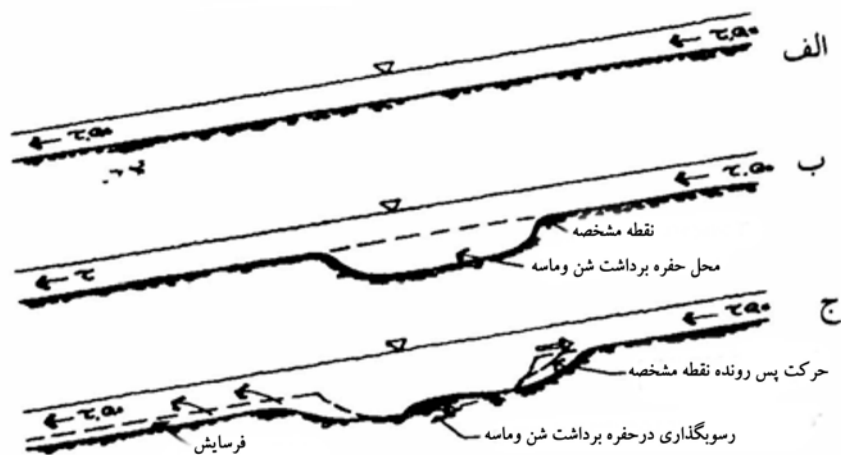
شکل ۵-۴۳- فروافتادگی ایجادشده بعلت برداشت شن و ماسه
