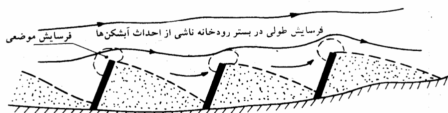
پ - وضعیت رسوبگذاری در سری آبشکن های بسته (از نوع جذبی)
