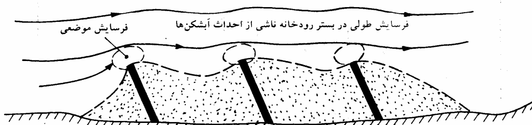
ت - وضعیت رسوبگذاری در سری آبشکن های بسته (از نوع دفعی)
