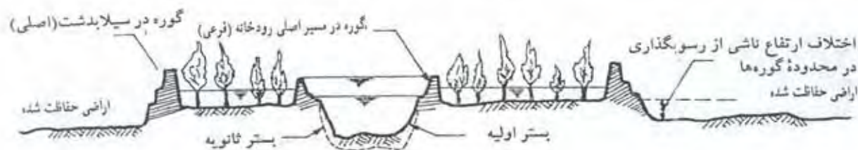
شکل ۵-۳۲ - مهار سیلاب توسط خاکریزهای ساخت شده در امتداد مجرای اصلی و سیلابدشت و پیامدهای فرسایشی و رسوبگذاری ناشی از آن [۱۲]
