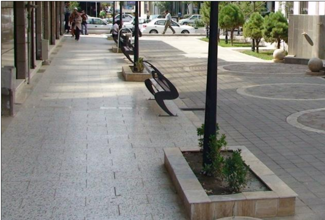
شکل ۷-۲- جانمایی مبلمان شهری در خارج از مسیر حرکت عابران پیاده
