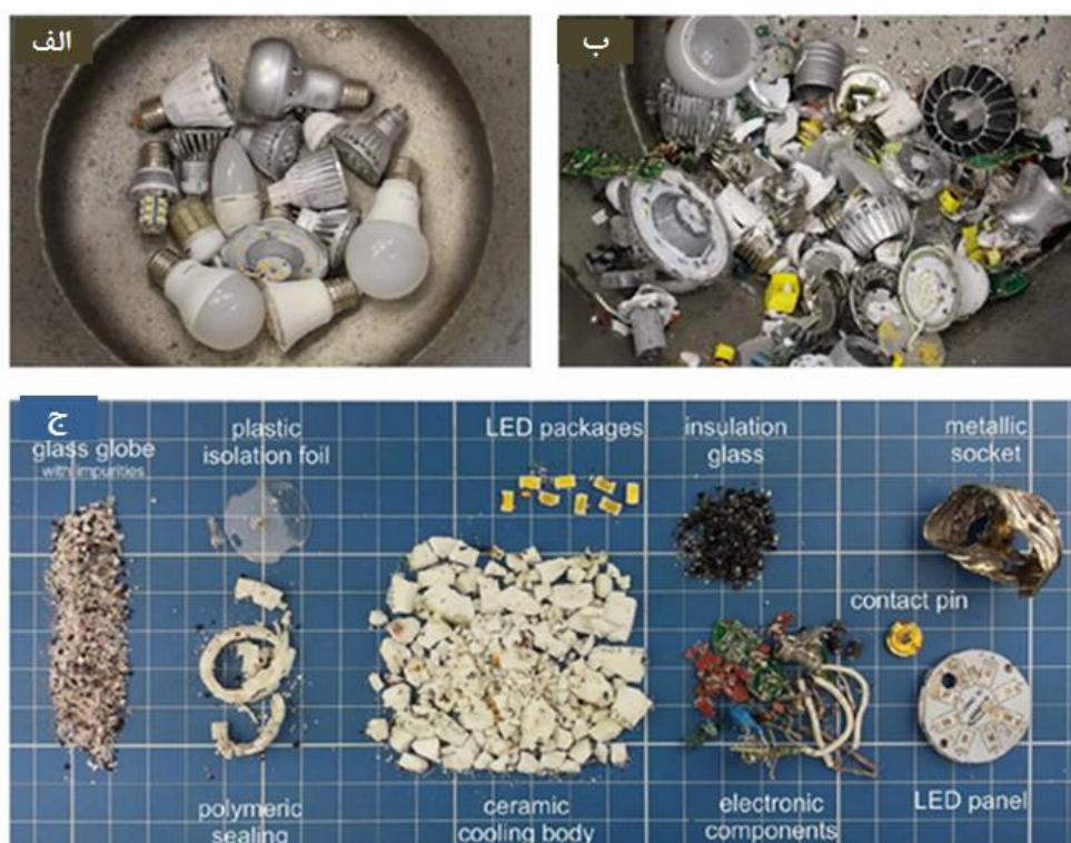
شکل ۷-۱۶: (الف) مخلوطی از زباله‌های LED قبل از EHF، (ب) ترکیب اجزا و مواد پس از EHF لامپ‌های ضایعاتی، (ج) بخش‌های بدست آمده از مرتب‌سازی اجزا پس از EHF
