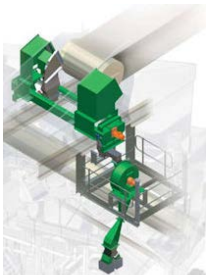
۱۰- نمونه‌گیر ثابت سرریز نوار نقاله
