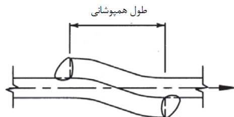
(الف) طول همپوشانی در اتصالات پوششی (جوش دو طرفه)
