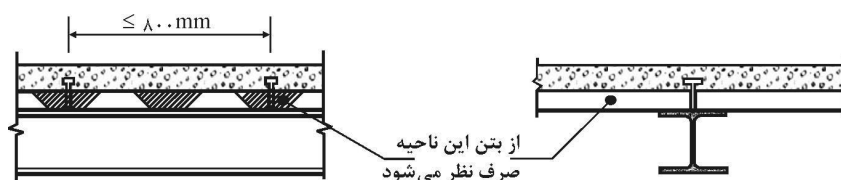
شکل ۲-۱۰-۵ ورق‌های فولادی شکل داده شده که کنگره‌های آنها عمود بر محور تیر می‌باشد
