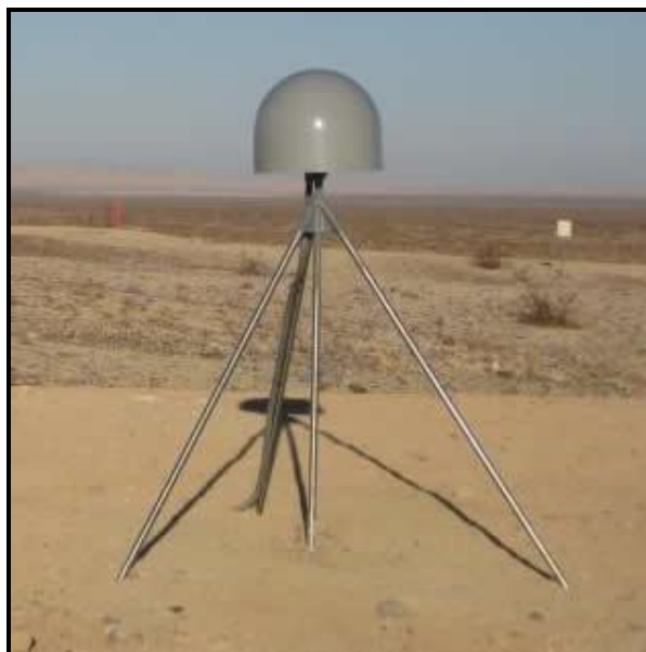
شکل ۲-۲۵- نمونه از بنای ساخته شده از نوع SBNDM
