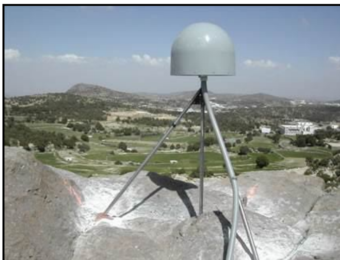
شکل ۲-۲۲- نمونه‌ای از بنای ساخته شده از نوع SDBM
