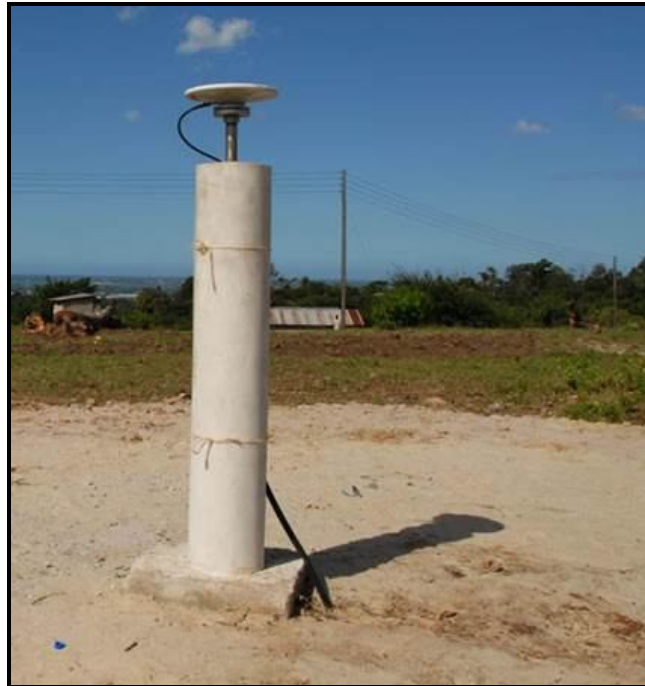
شکل ۲-۳۳- نمونه از ایستگاه GPS با ساختمان پیلار
