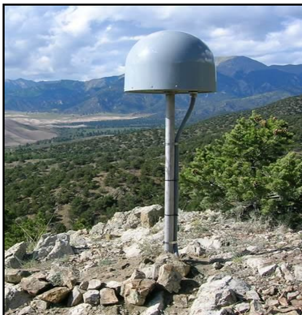
شکل ۲-۲۸- نمونه‌ای از بنای ساخته شده به صورت پایه با پی سطحی
