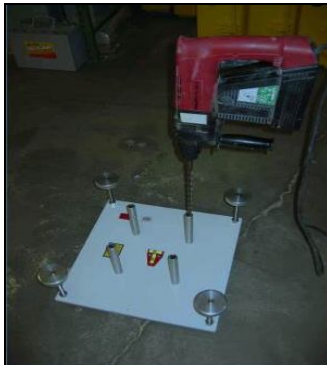
شکل ۲-۴۰- شابلن جهت دریل کاری موقعیت صحیح
