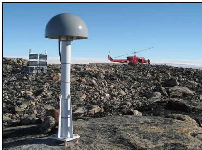
شکل ۲-۳۸- نمونه‌ای از پایه آلومینیومی
