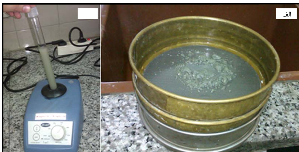
شکل ۶-۷- الف- نمونه ها از سری الک ۱ میلی متر و ۶۳ میکرون عبور داده شد، ب- باقیمانده آن ها در الک ۶۳ میکرومتر شستشو و به لوله آزمایش منتقل شد و به مدت ۳ دقیقه بر روی ورتکس قرار داده شدند.
