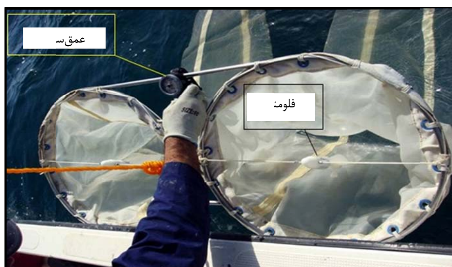
شکل ۵-۳- محل نصب عمق سنج دستی و فلومتر
