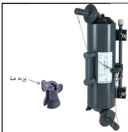
شکل ۴-۲- بطری نمونه بردار نیسکین و وزنه
