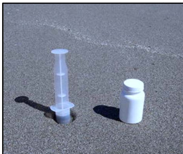
شکل ۶-۶- نمونه برداری از میوفونا در نواحی جزر و مدی ماسه‌ای
