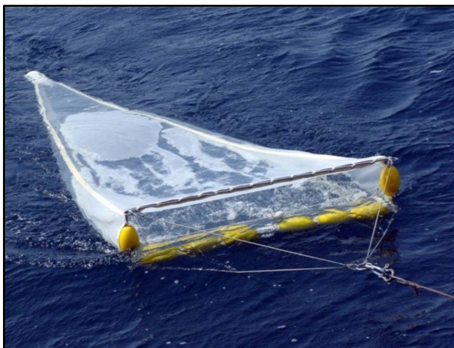
شکل ۵-۱۲- تور نوستون در حال کشیده شدن
