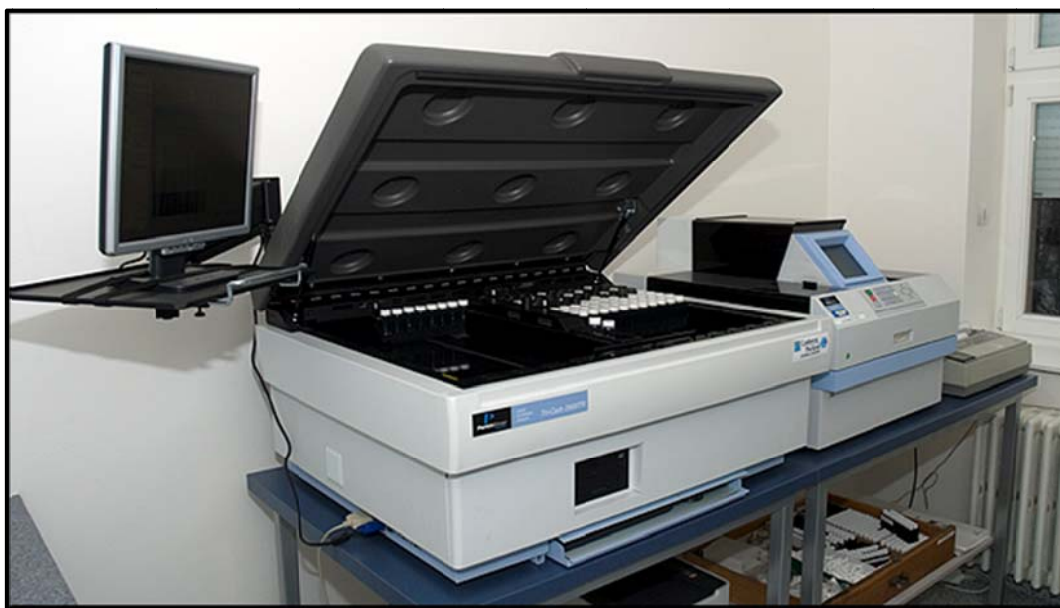
شکل ۴-۱- دستگاه شمارشگر مایع سینتیلایسیون Packard TRI-CARB 44301
