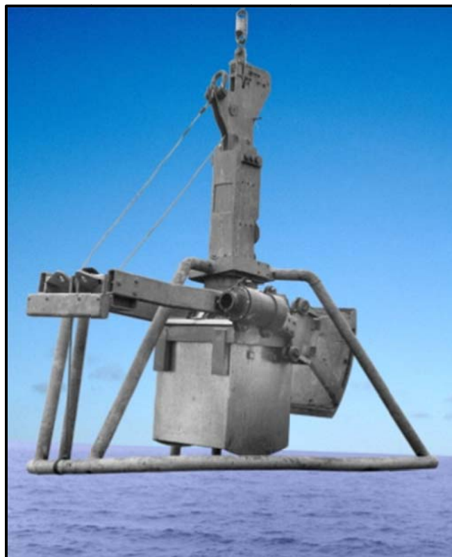
شکل ۶-۵- نمونه گیر Box corer
