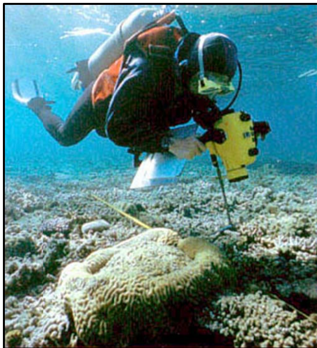
شکل ۶-۲۵- نحوه عملکرد ویدئو ترانسکت در بستر مرجانی
