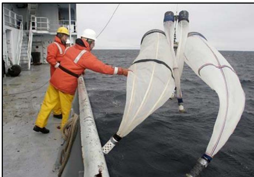
شکل ۵-۱- تور ژئوپلانکتون گیر بونگو
