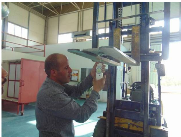
شکل ۵-۲- نحوه انجام آزمون تعیین مقاومت چسبندگی
