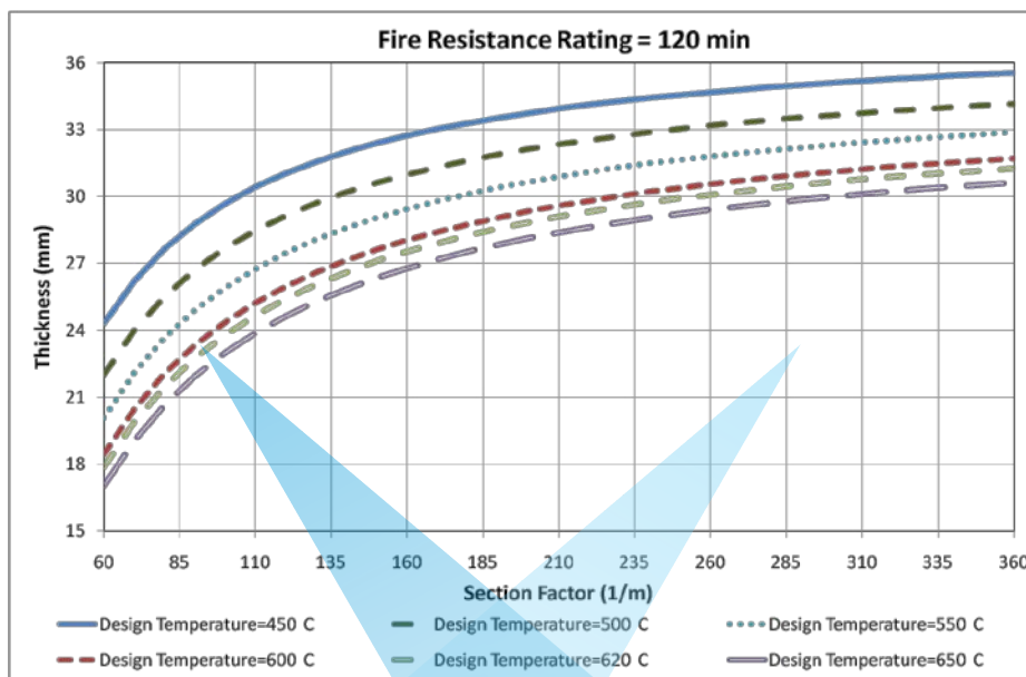
شکل ۴-۵- گراف‌های ضخامت پوشش محافظ معدنی برای ۲ ساعت مقاومت در برابر آتش
