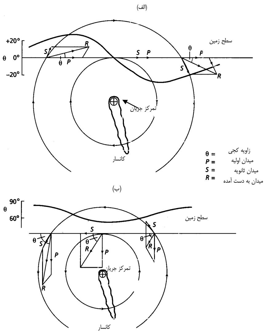
شکل ۷-۴-پروفیل‌های زاویه کجی، الف: لوپ فرستنده قائم، ب: لوپ فرستنده افقی
