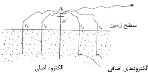
شکل ۱۹-۲- الکترودهای اضافی جریان، الف: الکترودهای اضافی که در یک خط راست عمود بر امتداد آرایه قرار می‌گیرند، دارای ضریب آرایه هستند. ب: با افزایش تعداد الکترودهای اضافی مقاومت تماس با زمین کاهش می‌یابد.
