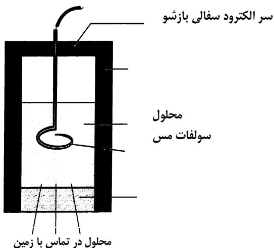
شکل ۳-۵- مقطع یک الکترود سفالی متخلخل
