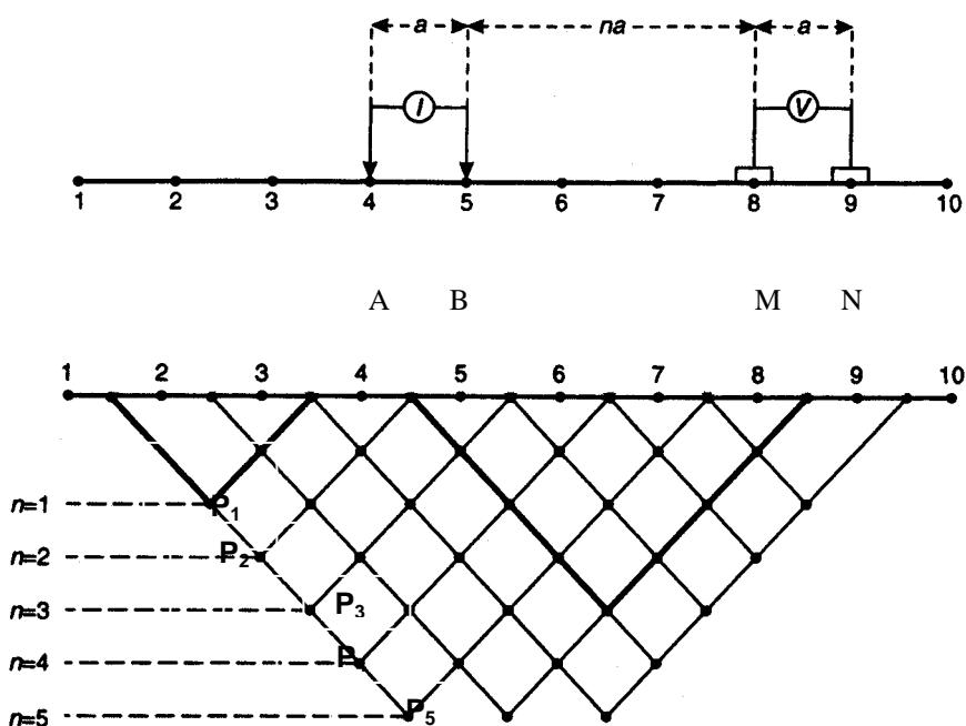
شکل ۷-۳- چگونگی اجرای آرایه دوقطبی-دوقطبی برای تهییه شبه مقطع عمق
