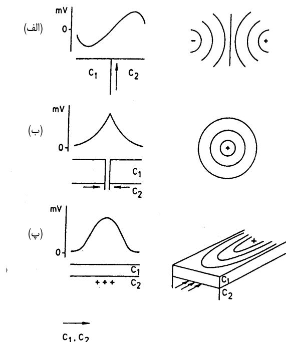
شکل ۱-۵- نیمرخ‌ها و نقشه‌های SP الکتروفیلتراسیون در حالت ایده‌آل، الف: مرز قائم لایه‌ها و عبور آب به طرف بالا، ب: پمپاز از یک چاه، پ: جریان آب در مرز افقی دو لایه
