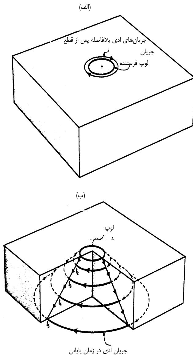
شکل ۴-۱۳- چگونگی انتشار جریان‌های ادی، الف: بلافاصله پس از قطع میدان اولیه، ب: انتشار جریان‌های هادی به سمت پایین و پیرون در بازه‌های متوالی زمانی ( $t_1, t_2, t_3, \dots$ ) بر روی زمین همگن
