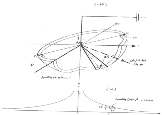
شکل ۲-۱- چگونگی شارش جریان و تشکیل سطوح همپتانسیل در یک زمین همگن و همسانگرد،
