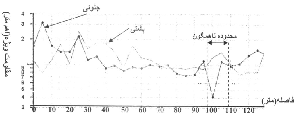
شکل ۱۴-۲- نمونه‌ای از منحنی‌های مقاومت ویژه ظاهری در اندازه‌گیری‌های نیمرخ تکراری
