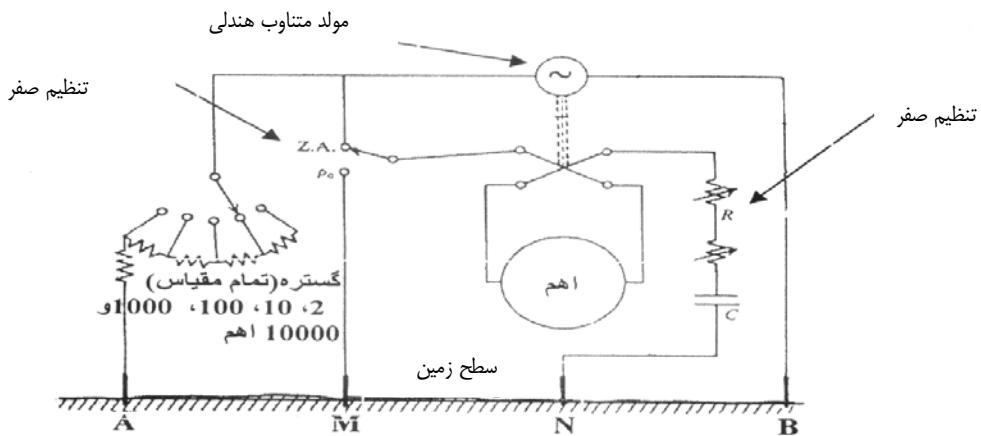
شکل ۲-۱۸-۲ - دستگاه قابل حمل اندازه‌گیری مقاومت ویژه
