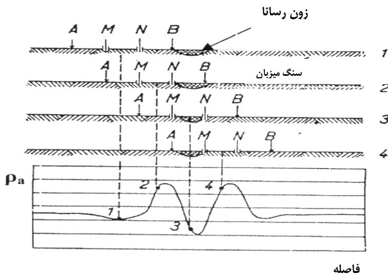
شکل ۱۲-۲- تغییرات مقاومت ویژه ظاهری در عبور الکترودها از روی یک زون رسانا
