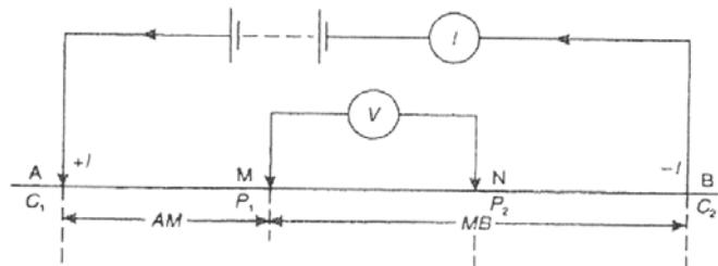
شکل ۳-۲-یک آرایه چهار الکترودی که در آن الکترودهای پتانسیل بین الکترودهای جریان قرار دارند.
