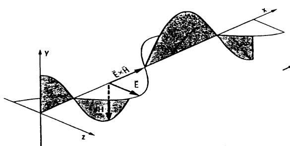
شکل ۴-۱- اجزای پایه موج الکتروومغناطیسی مرکب از دو مؤلفه اصلی  $E$  و  $H$  نشان داده شده است.
