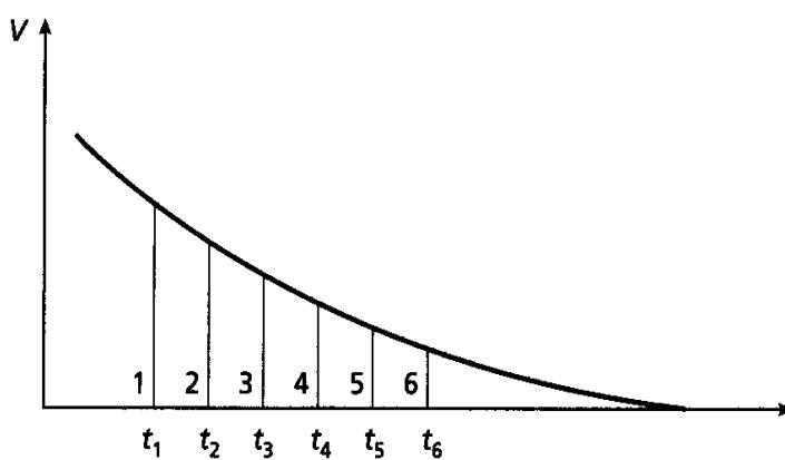
شکل ۴-۱۴- ارزیابی کمی فروپاشی پاسخ زمان- حوزه‌ای الکترومغناطیسی با اندازه‌گیری دامنه میدان ثانویه در تعدادی کanal (۱ تا ۶) در بازه‌های زمانی ( $t_{1-6}$ ) پس از قطع میدان اولیه میسر می‌شود.
