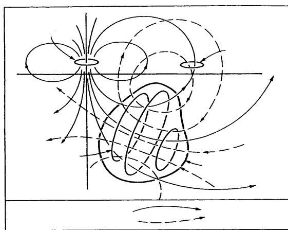
شکل ۴-۴- چگونگی توزیع میدان‌های الکتروومغناطیسی در یک محدوده کانی‌سازی فلزی
