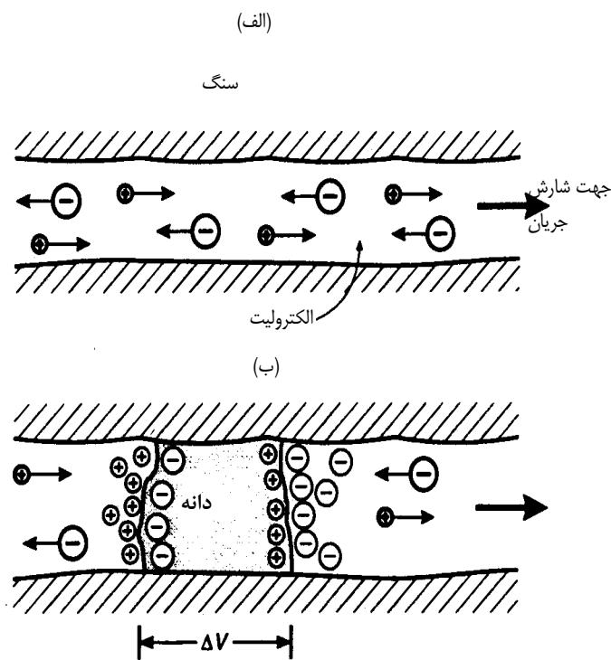
شکل ۳-۳- پلاریزاسیون الکترودی، الف: شارش بدون مانع الکتروولیت در یک کانال باز ب: پلاریزاسیون یک دانه رسانا که در کانال ارتباطی سنگ قرار گرفته است.
