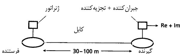
شکل ۴-۱۱- تجهیزات برداشت‌های الکتروومغناطیسی با فرستنده و گیرنده متحرک
