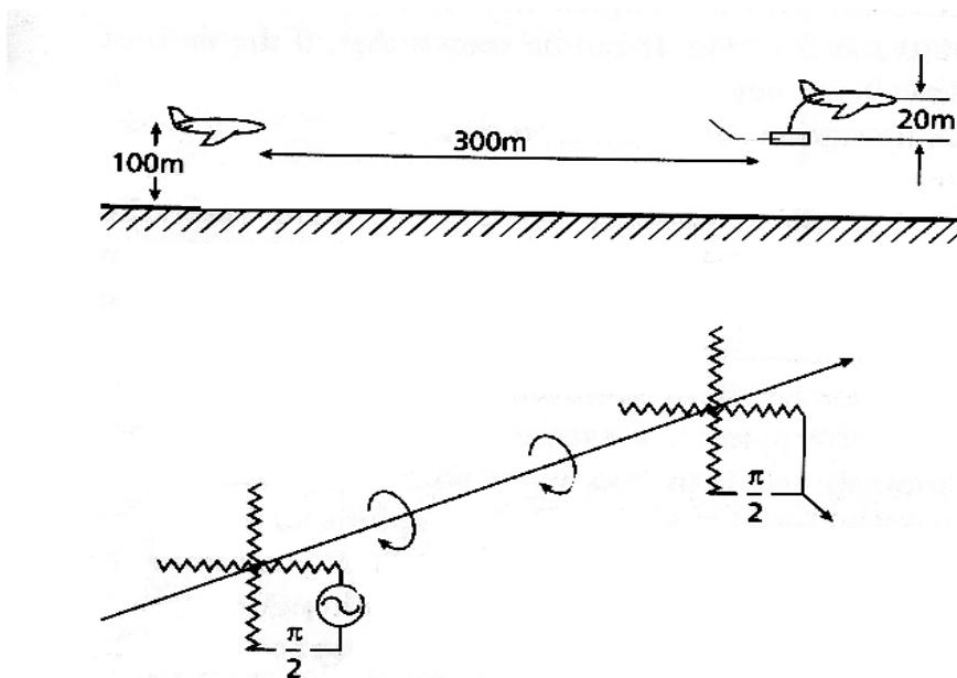
شکل ۴-۶- سیستم الکترومغناطیسی هوابردی با دو هواپیما و میدان چرخشی
