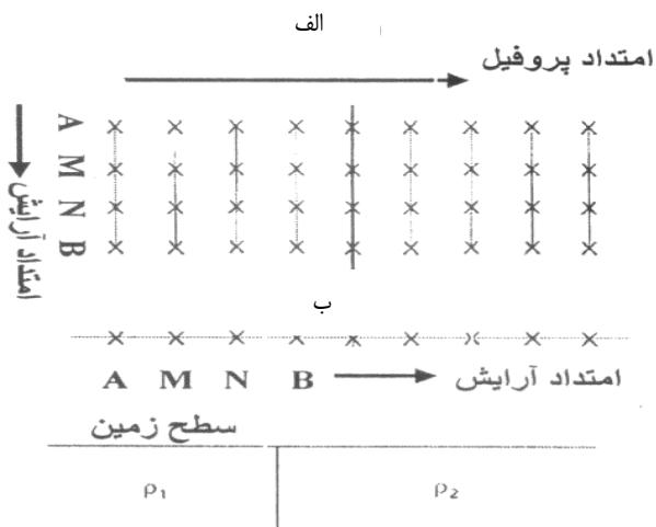
شکل ۱۰-۲- جابه‌جایی آرایه در روی سطح زمینی با تباين قائم مقاومت ویژه، الف: عمود، ب: هم‌امتداد
