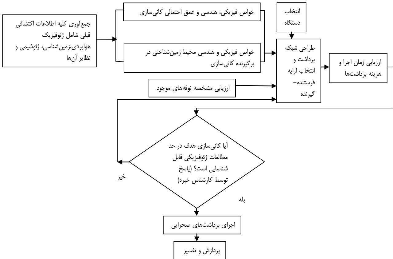
شکل ۱-۶- طراحی عملیات ژئوفیزیکی به روشن‌های مقاومت ویژه، پلاریزاسیون القایی، پتانسیل خودزا و الکترومغناطیسی تا مرحله پردازش و تفسیر
