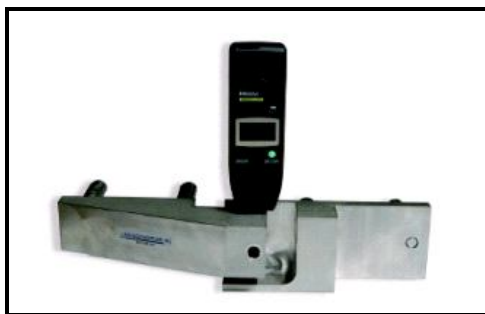
شکل ۱۰-۸- درزسنج تک بعدی و درزسنج سه بعدی به همراه گیج مکانیکی اندازه گیری [۱۱، ۱۲]
