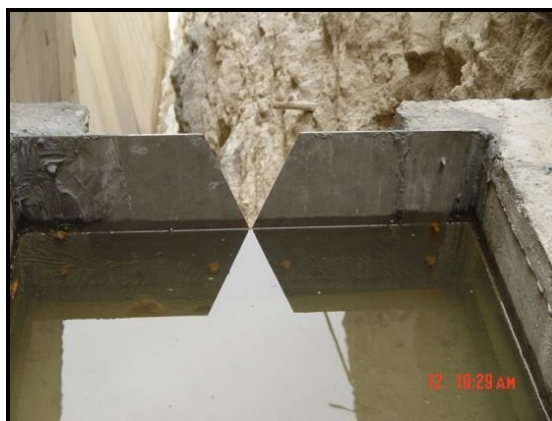
شکل ۱۰-۹- ایستگاه بده‌سنجی با سرریز استاندارد V شکل [۱۱، ۱۲]
