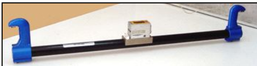
شکل ۱۰-۷- میله اندازه‌گیری ابزار شیب‌سنج [۱۱، ۱۲]
