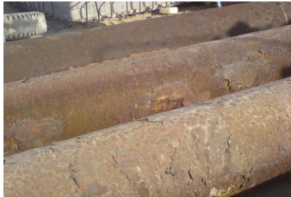
شکل الف-۱۳- خوردگی شمع فولادی در مجاورت دریا در فاصله زمانی بین انبار کردن تا اجرا به علت عدم حفاظت در برابر خوردگی
