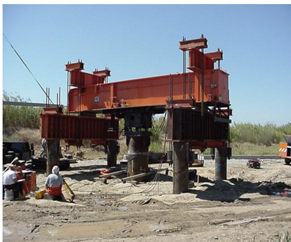
شکل الف-۲۱- تست بارگذاری استاتیکی فشاری با استفاده از سربار مرده (تصویر سمت راست) و شمع‌های مهارتی (تصویر سمت چپ)
