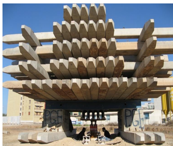
شکل الف-۲۱- تست بارگذاری استاتیکی فشاری با استفاده از سربار مرده (تصویر سمت راست) و شمع‌های مهارتی (تصویر سمت چپ)
