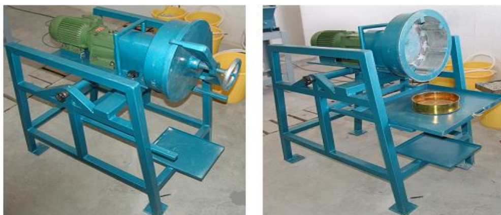
شکل ۲-۷- یک آسیای نیمه‌خودشکن آزمایشگاهی
