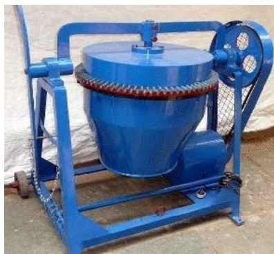
شکل ۲-۲۳- نمونه‌ای از مخلوط‌کن مخروطی
