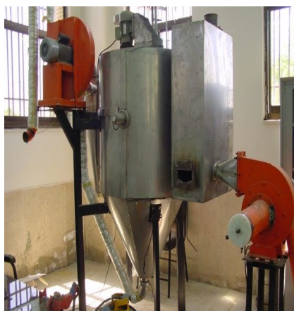
شکل ۲-۲۵- خشک‌کن با حجم کم (سمت راست) و خشک‌کن آزمایشگاهی در حجم زیاد (سمت چپ)
