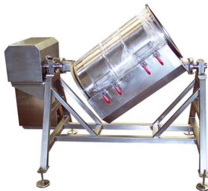
شکل ۲-۲۲- نوعی مخلوط‌کن استوانه‌ای
