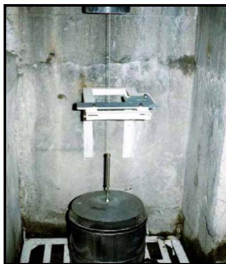
شکل پ.۵-۹- نحوه نصب و قرارگیری پاندول مستقیم
