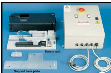
شکل پ. ۵-۱۱- دستگاه قرائت سنج انحرافات کابل پاندول معکوس
