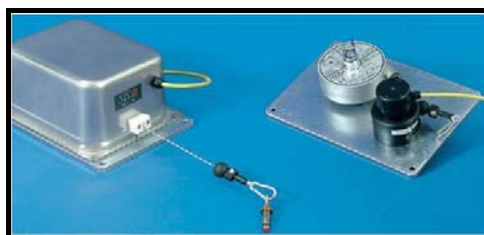
شکل پ.۵-۲۹- درز سنج با سیم ارتعاشی سیار
