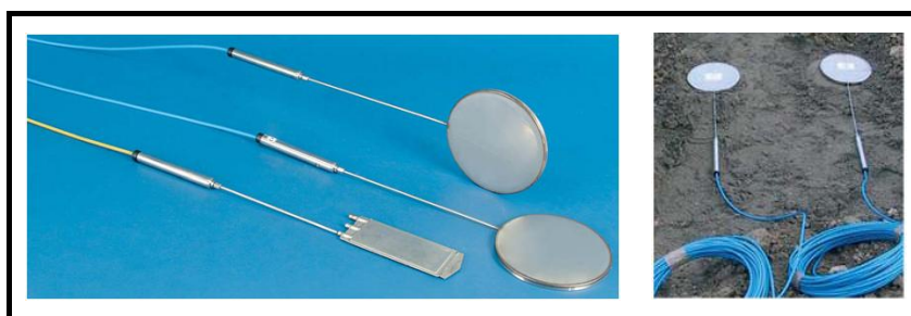
شکل پ.۵-۴-۳- انواع تنش‌سنج‌ها
