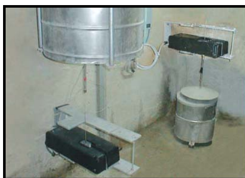
شکل پ. ۵-۱۲- نحوه نصب و قرارگیری پاندول معکوس
