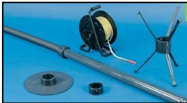
شکل پ.۵-۱۸- نشست‌سنج مغناطیسی
