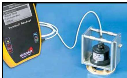
شکل پ.۵-۱۳- انحراف‌سنج سیار (Tiltmeter)
