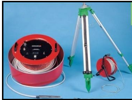
شکل پ. ۵-۱۹- نشست‌سنج هیدرولیکی
