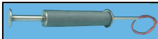
شکل پ.۵-۲۸- درز سنج با سیم ارتعاشی مدفون
