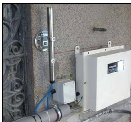
شکل پ. ۵-۲۵- نحوه قرارگیری شیب یاب سطحی (Inclinometer)
