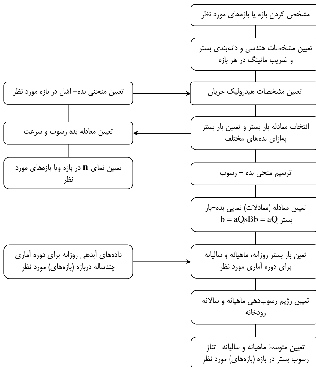
شکل ۶-۱۷- نمودار مراحل مختلف تعیین بار بستر رودخانه (شن و ماسه حمل شده) و رژیم رسوب‌دهی با استفاده از معادلات رسوب [۱۰]
