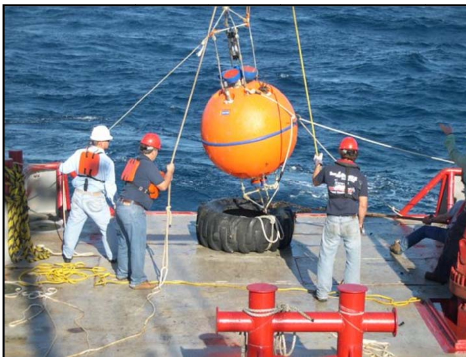
شکل ۳-۲۶- دستگاه مستقر بر گوی شناور که پس از مستقرسازی رو به پایین قرار می‌گیرد
