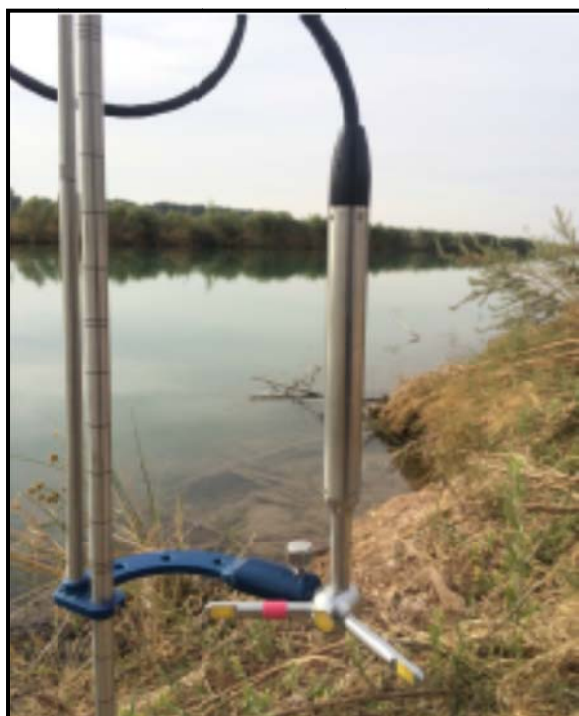
شکل ۳-۱۳- بست J شکل برای نصب
