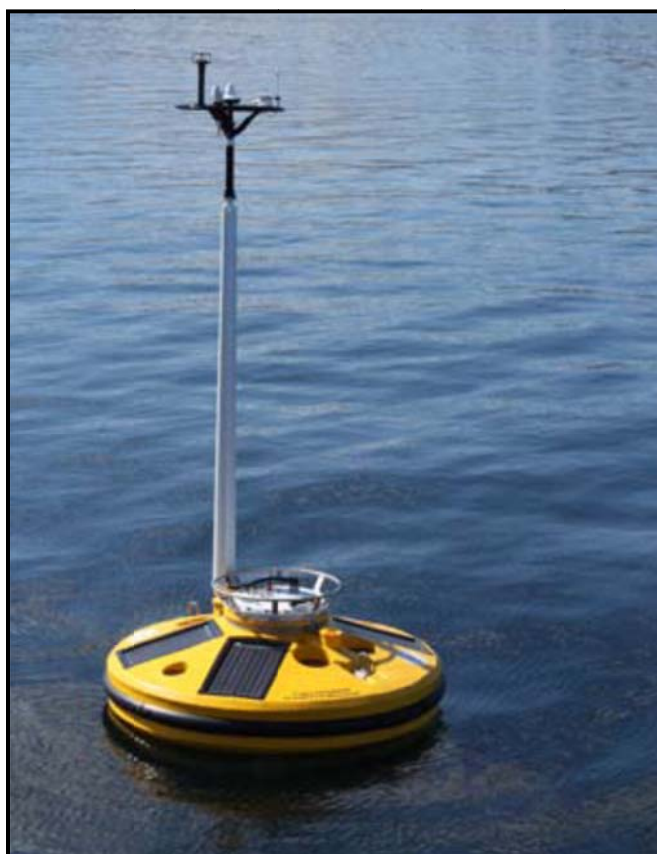
شکل ۴-۳۶- گوی شناور موج نگار مجهز به حس‌گرهای هواشناسی
