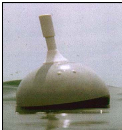
شکل ۴-۲۶- شناور سرگردان سطحی مجهز به فشارسنج هوا
