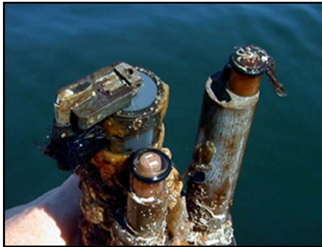
شکل ۲-۲۲- رسوبات زیستی بر روی حس‌گرهای دستگاه
