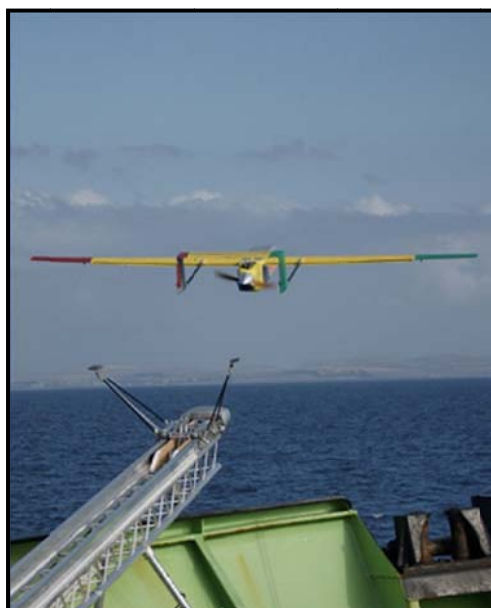
شکل ۲-۹۷- پرتاب ترابر هوایی بدون سرنشین از RRS Discovery
