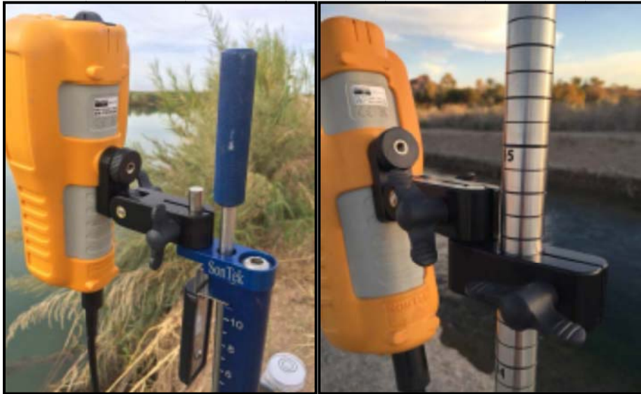
شکل ۳-۱۴- بست نصب قسمت دست گرفت بر روی میله
