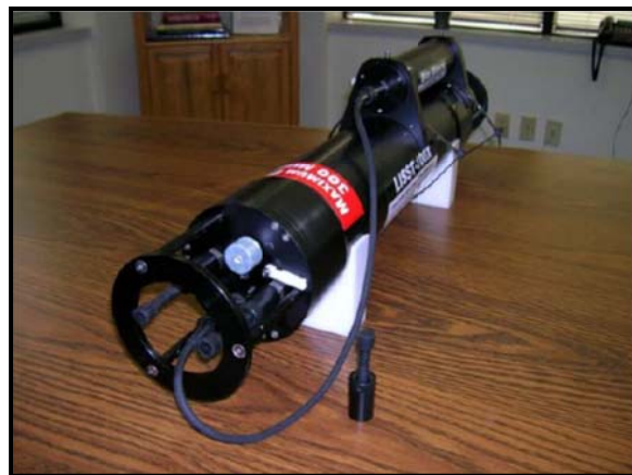
شکل پ.۱-۱۴- اتصال کابل ضد رسوب به دستگاه
