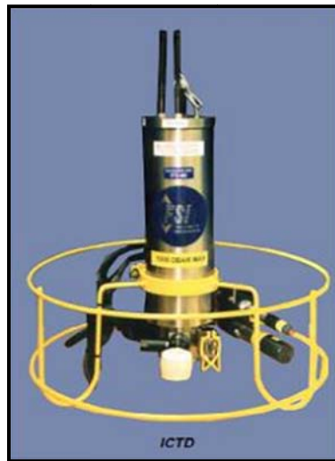
شکل ۲-۵۱- سامانه سنجنده عمق، دما و شوری مجهز به فشارسنج‌های سیلیکونی
