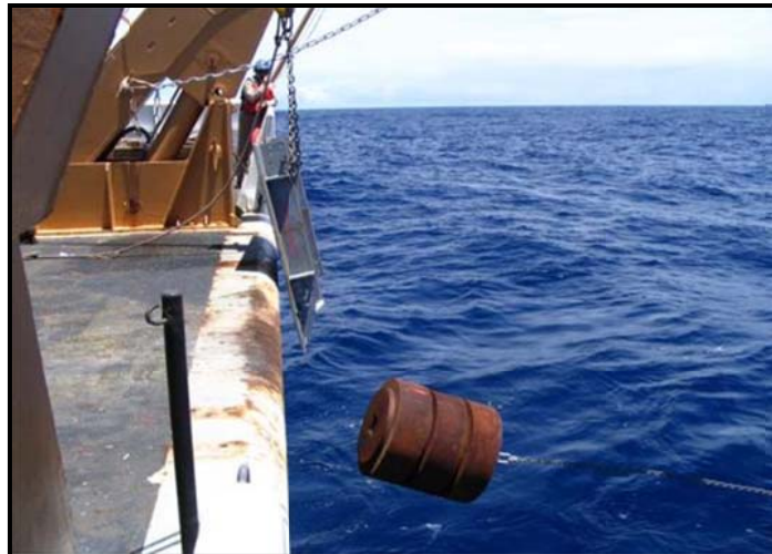
شکل ۳-۷۷- مستقر سازی لنگر، زمانی که تمام وسایل و دستگاه‌ها متصل و رها ساز صوتی مستقر شده است
