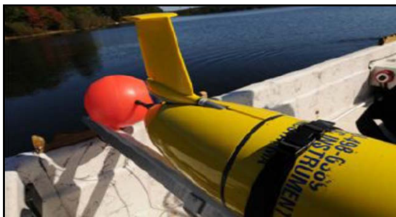
شکل ۲-۸۵- ترابر با گوی شناور و طناب آماده برای مستقرسازی اولیه
