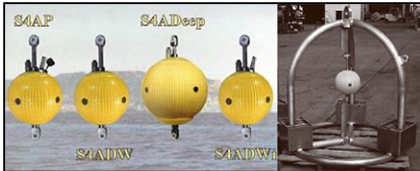
شکل ۳-۴۰- شمای جریان‌سنج الکترومغناطیسی برای اعماق سطحی و عمیق و شمای جریان‌سنج با چارچوب مربوطه برای اندازه‌گیری جریان در کف (نزدیک بستر دریا)
