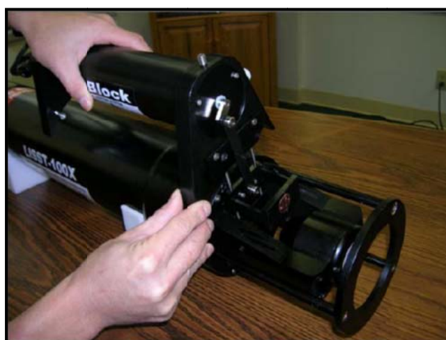
شکل پ. ۱-۱۰- چگونگی قرار دادن ضد رسوب در بین قسمت‌های مثلثی شکل تعبیه‌شده روی دستگاه
