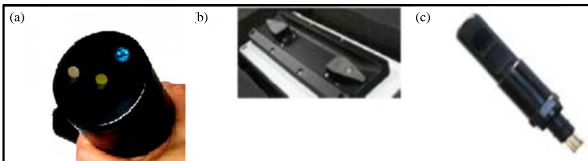
شکل ۲-۷۴- (a) سنجنده هم‌زمان پراکنش و پرتو حاصل از برانگیختگی (b) سنجنده تضعیف امواج سوار شده بر تراهر (c) کدورت‌سنج
