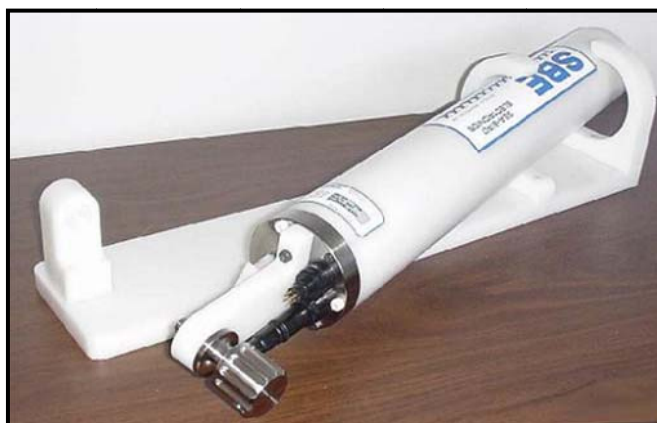
شکل ۲-۵۳- موج و جزرومدسنج مجهز به حس‌گر فشارسنج کوارتزی
