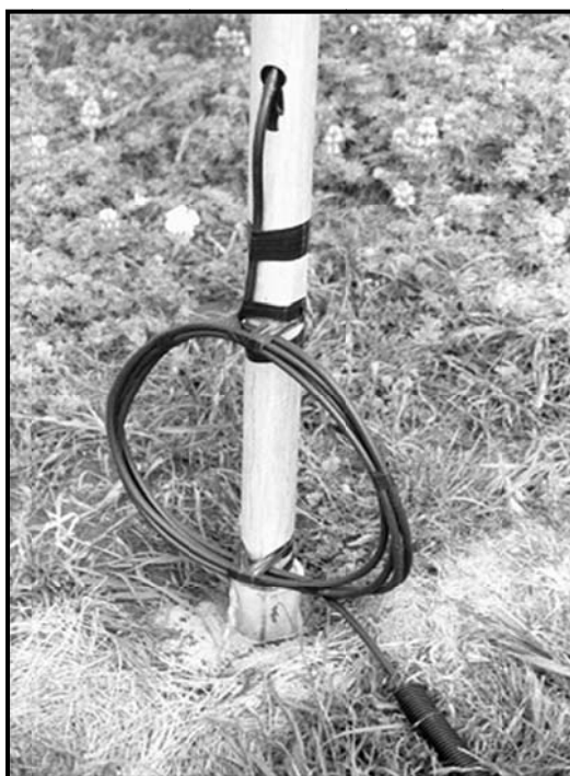
شکل ۳-۵۱- نمایشی از کابل پیچیده شده به صورت دایره‌وار
