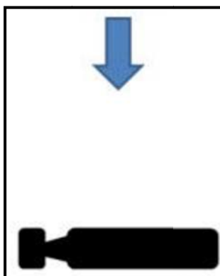
ب- دستگاه باید عمود بر جهت جریان قرار داده شود (نمای از بالای راستای جریان)
