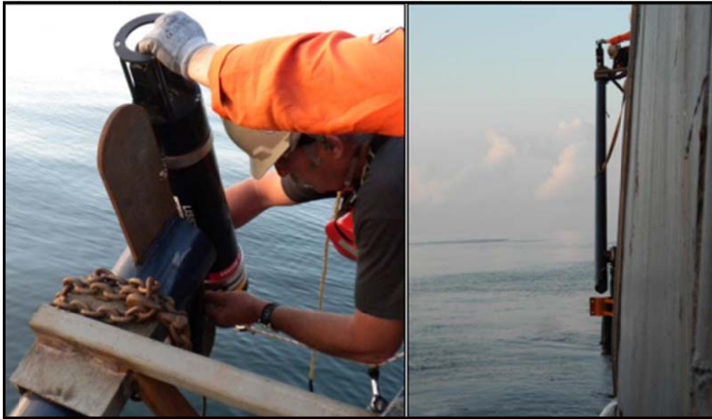
شکل ۲-۵۸- استفاده از سنجنده توزیع اندازه ذرات و غلظت جرمی، برای مطالعه توزیع اندازه ذرات و غلظت حجمی ذرات، مستقرسازی شد. یک سری زمانی کوتاه از داده سطحی با استفاده از یک تیرک نصب‌شده روی بدنه ناو تحقیقاتی (سمت راست)، جمع‌آوری می‌شود.
