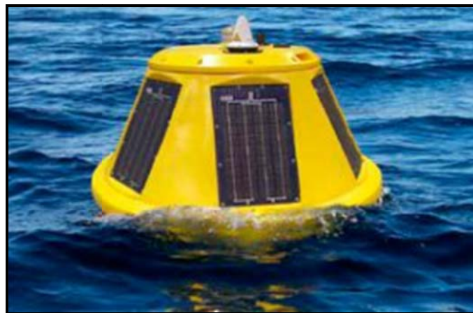
شکل ۳-۵۷- گوی شناور موج نگار در آب‌های ساحلی
