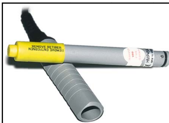
شکل ۴-۳- حس گر رطوبت سنج قابل نصب بر برج هواشناسی
