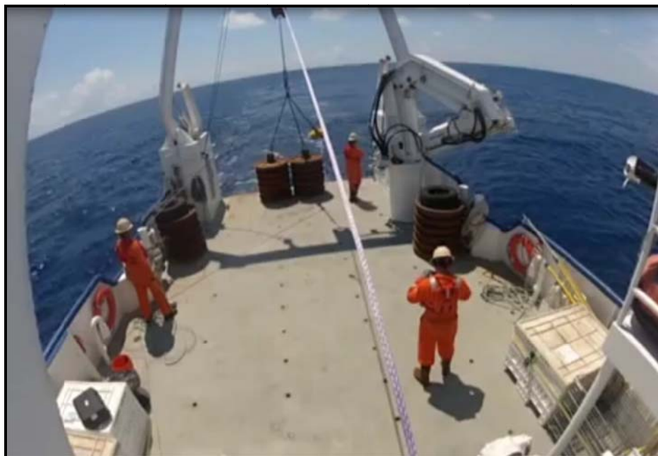
شکل ۳-۶۵- لنگرهای آماده برای استقرار
