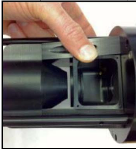
شکل پ.۱-۶- قرار دادن محفظه در مسیر وابسته به نور
