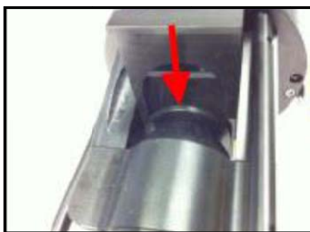
شکل پ.۱-۸- جای گیری Spacer بین دیواره‌ی خارجی محفظه و لبه‌ی Slider
