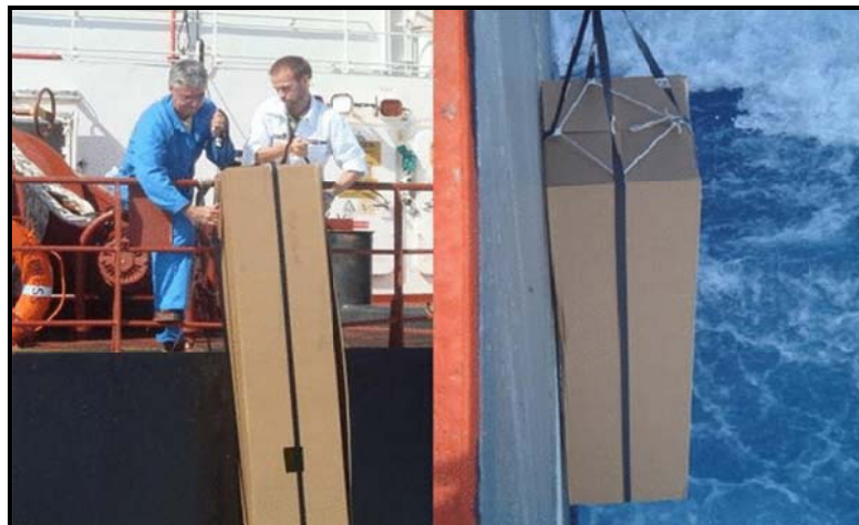
شکل ۳-۴۹- مستقرسازی با استفاده از یک سیستم مهار ایمنی با سازوکار رهایی در آب
