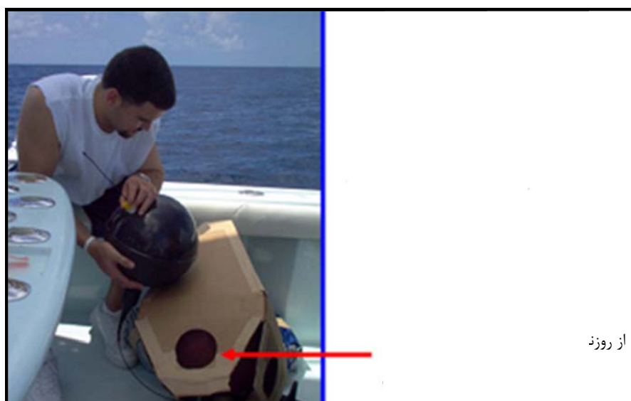
شکل ۴-۳۳- روزنه‌ی ایجادشده روی جعبه برای جدا کردن آهنربا
