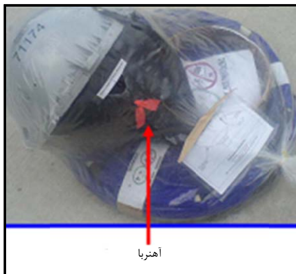
شکل ۴-۳۲- آهنربای تعبیه‌شده روی شناور سطحی
