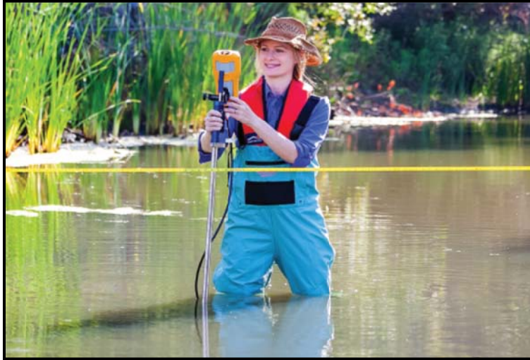
شکل ۳-۱۲- ردیاب جریان بر فراز میله نصب
