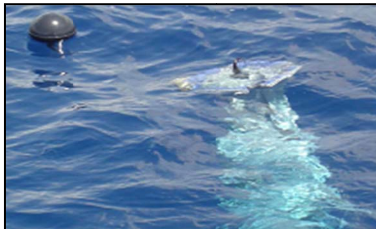
شکل ۴-۳۵- گسترده شدن عمودی مهار چتری، پس از تجزیه‌ی نوار
