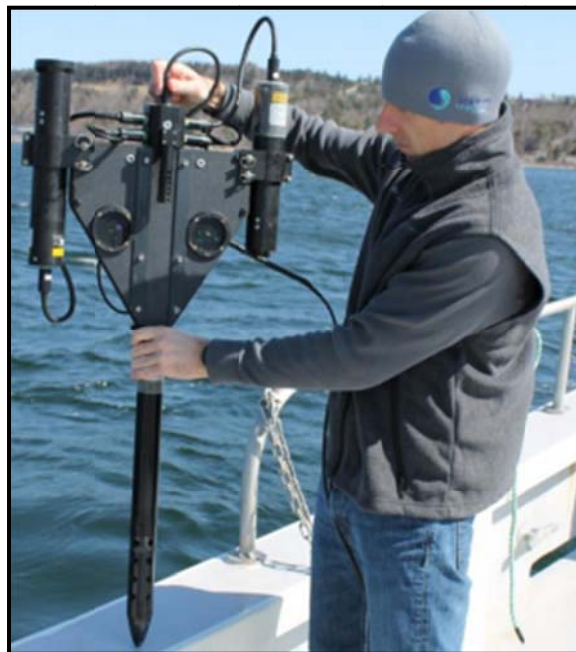
شکل ۲-۵۹- ابزارهای مختلف سنجنده ویژگی‌های وابسته به نور، (از جمله سنجنده‌ی تابندگی بر واحد سطح فرو شارش (Downwelling) و تابندگی فراشارش (Upwelling) چند طیفی) روی این نیمرخ بردار نصب می‌شود که می‌توان آن را در ستون آب، آزادانه یا توسط یک مهار، پایین برد.
