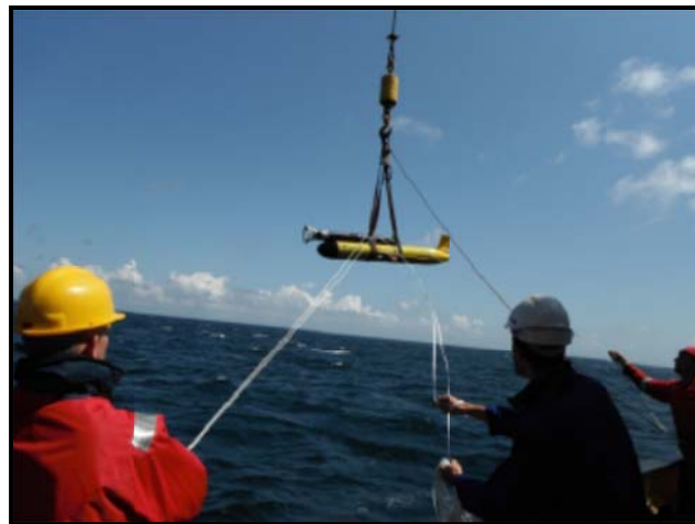
شکل ۲-۸۹- مستقرسازی ترابر از روی کشتی
