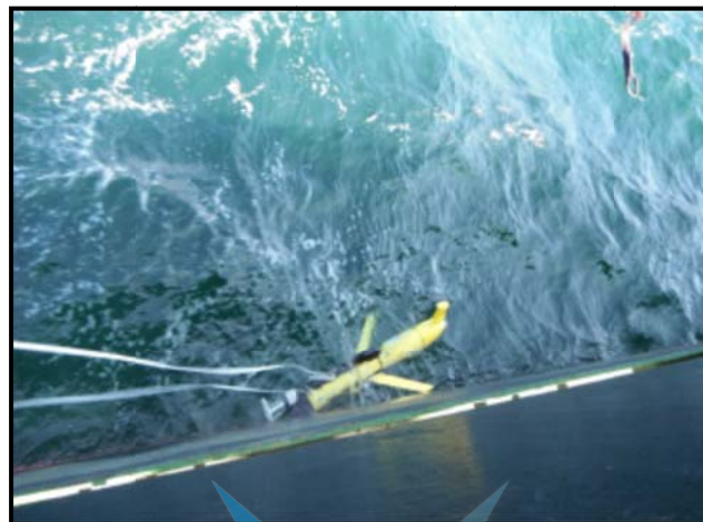
شکل ۲-۹۰- برخورد ترابر با بدنه کشتی
