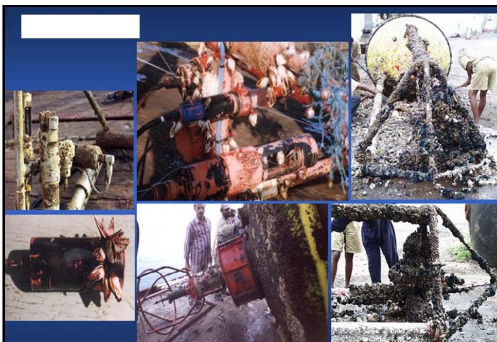
شکل ۳-۸۰- رسوب‌های زیستی بر روی دستگاه
