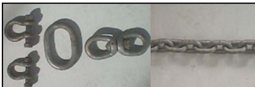
شکل ۳-۶۰- بست و زنجیر مورد استفاده برای نصب
