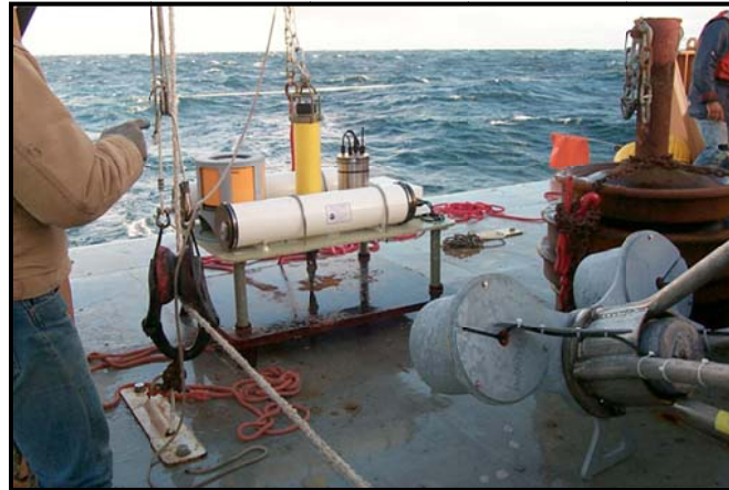
شکل ۳-۷۳- ثبت‌کننده فشار بستر آماده برای استقرار
