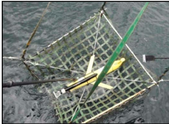
شکل ۲-۹۶- تیرک‌های محافظ ضربه‌گیر برای بازیابی دستگاه
