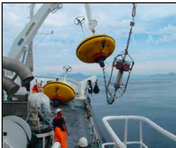
شکل ۴-۳۸- انتقال گوی شناور به موقعیت موردنظر
