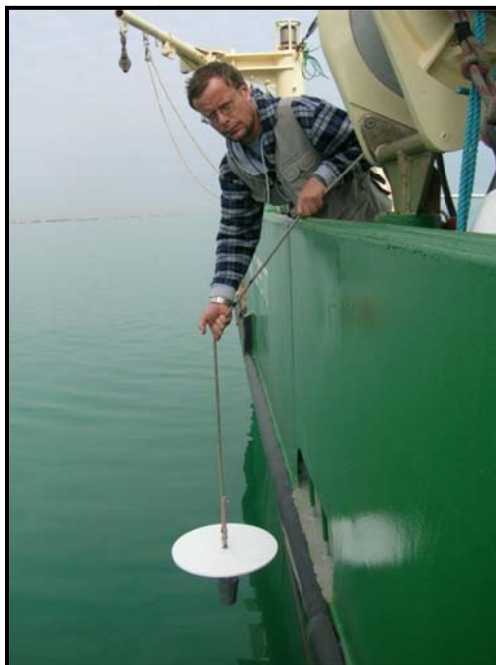
شکل ۱-۲- سنجش کدورت با استفاده از صفحه سشی در دریا
