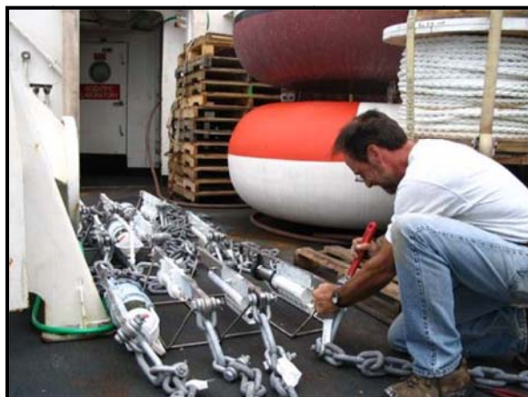
شکل ۳-۷۰- آماده‌سازی بست و زنجیرهای لازم برای مستقرسازی‌های زیر گوی شناور
