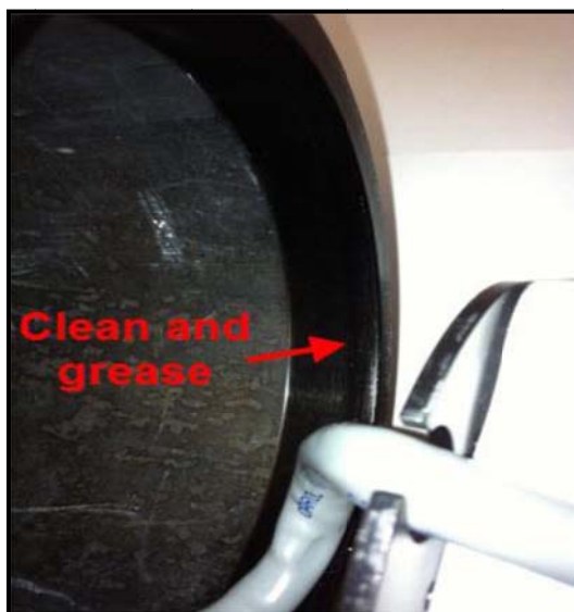
شکل ۲-۱۷- تمیز و روغن‌کاری داخل قطر محفظه‌ی فشار
