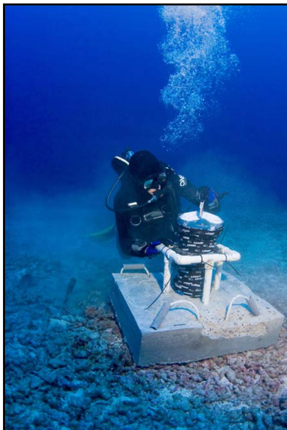
شکل ۳-۵۵- مستقرسازی نیمرخ بردار صوتی داپلری برای اندازه‌گیری موج
