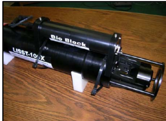
شکل پ.۱-۱۳- بست‌های کمربندی، برای محکم نگه‌داشتن بدنه‌ی ضد رسوب به دستگاه
