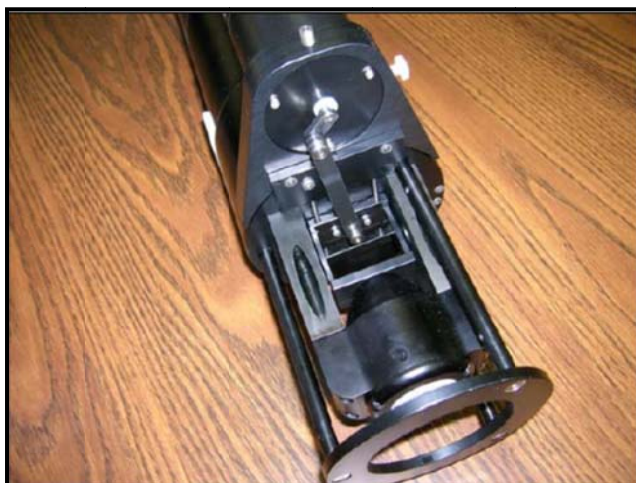
شکل پ.۱-۱۲- قرار دادن مسدودکننده‌ی ضد رسوب
