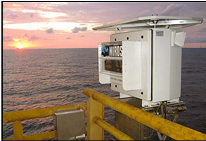
شکل ۳-۸۴- رادار ریزموج داپلر پالسی دریافت‌کننده موج در یک محدوده مشخص
