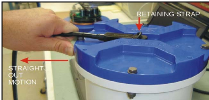
شکل ۳-۳۱- طریقه صحیح جدا نمودن کابل اتصال
