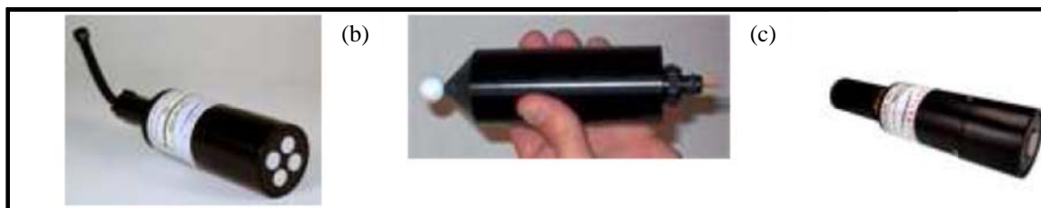
شکل ۲-۷۵- (a) حس گر تابندگی (b) حس گر تابش فعال فروغ آمایی (c) حس گر تابش فعال فروغ آمایی
