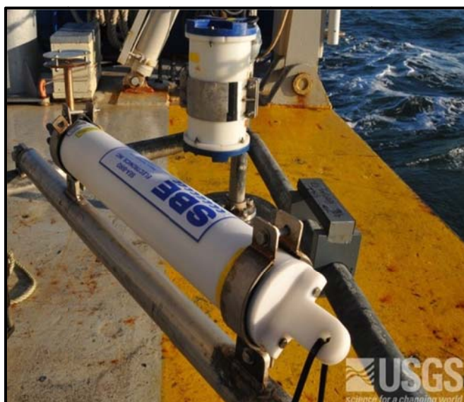
شکل ۲-۵۴- نمایی از موج و جزرومدسنج مجهز به حس‌گر فشارسنج کوارتزی قبل از مستقرسازی
