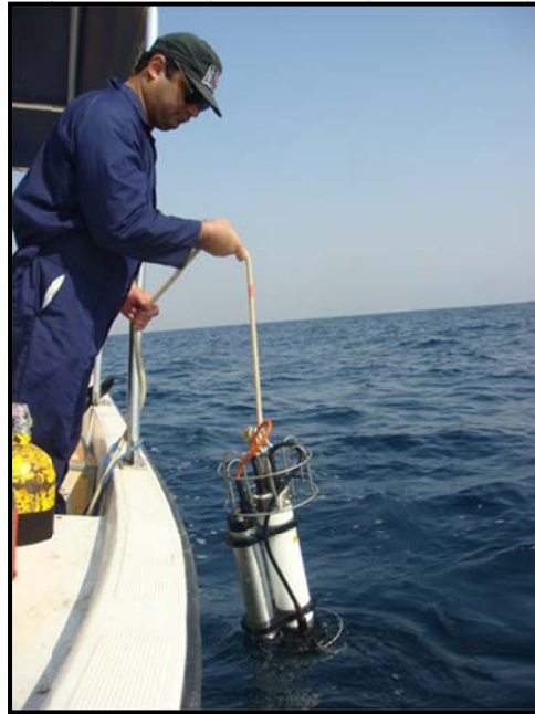
شکل ۲-۲۱- مستقرسازی سنجنده‌ی عمق، دما و هدایت الکتریکی
