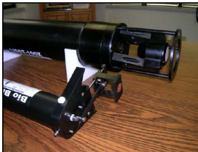
شکل پ. ۱-۹- ضد رسوب در موقعیت بسته (دریچه‌های پوشیده شده)
