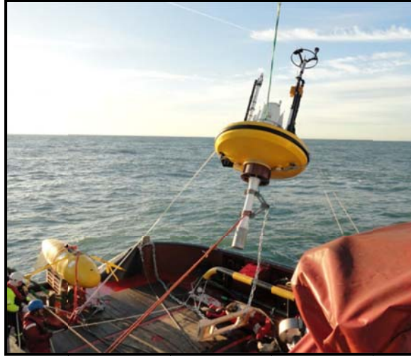
شکل ۴-۴۰- مستقرسازی گوی شناور مجهز به لایدار
