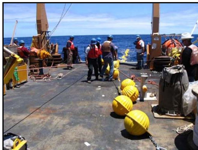
شکل ۳-۷۵- توپ‌های شیشه‌ای قرار داده شده درون محفظه‌های پلاستیکی زردرنگ که به لنگر بسته می‌شود
