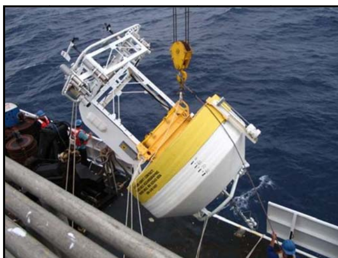
شکل ۳-۷۱- بلند کردن گوی شناور از روی کشتی برای مستقرسازی
