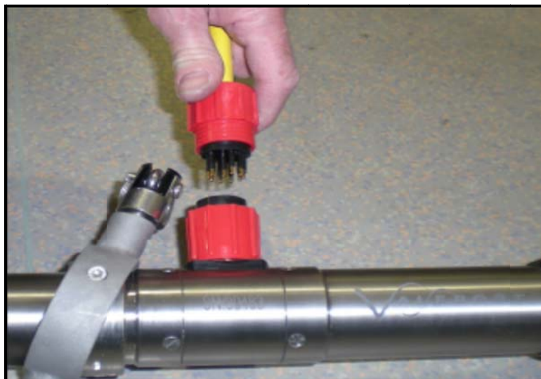
شکل ۳-۸- اتصال درپوش انتقال Subconn
