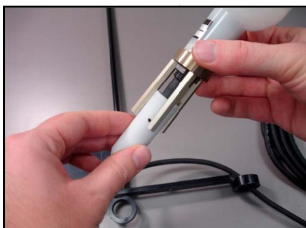
شکل ۲-۶۵- اتصال قطعه محافظ
