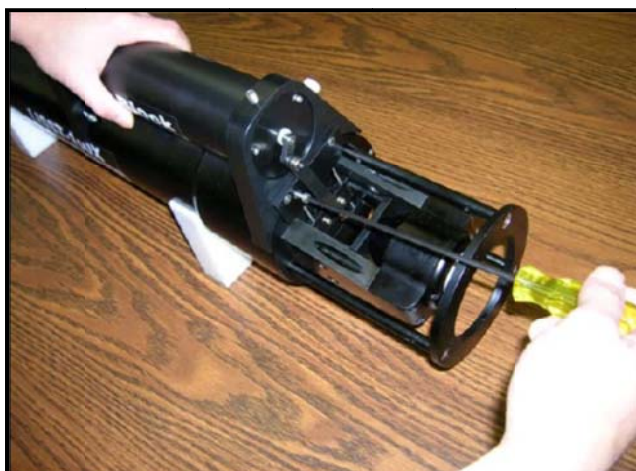
شکل پ.۱-۱۱- خارج کردن یکی از پیچ‌های روی درپوش انتهایی دستگاه
