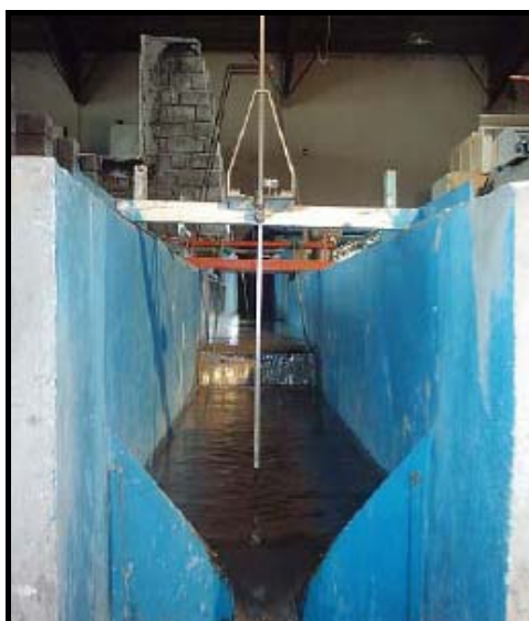
شکل ۲-۲- تجهیزات اندازه‌گیری بده
