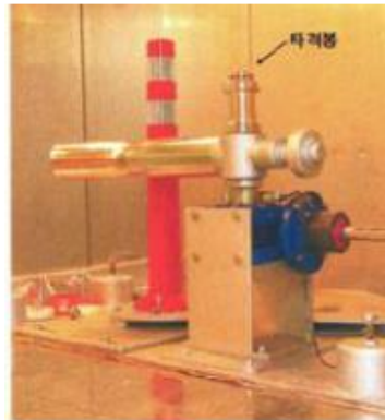
شکل و-۵-۹: آزمون عملکرد میدانی استوانه ارتجاعی
