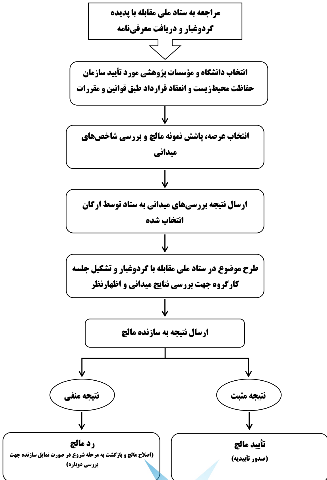
شکل ۶-۱- روند بررسی مواد تثبیت‌کننده خاک (مالچ) در سطح عرصه
