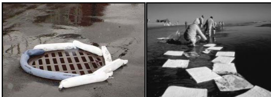
شکل پ.۴-۵۷- نمونه‌ای از کاربرد بوم‌ها و ورقه‌های جاذب نفت
