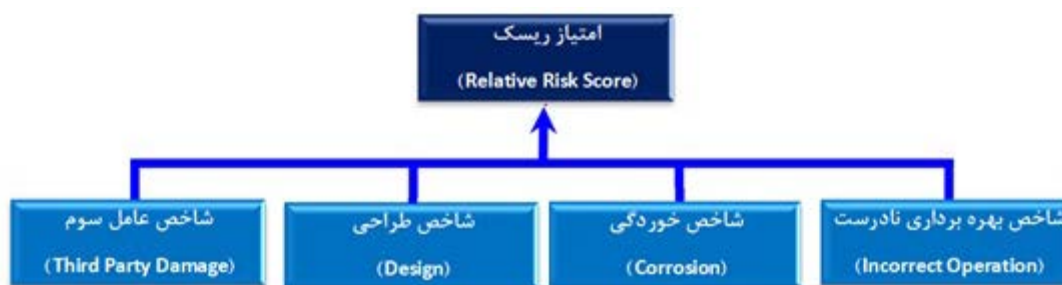
شکل ۳-۵- ساختار برآورد ریسک شکست خطوط لوله و اجزای تشکیل دهنده آن
