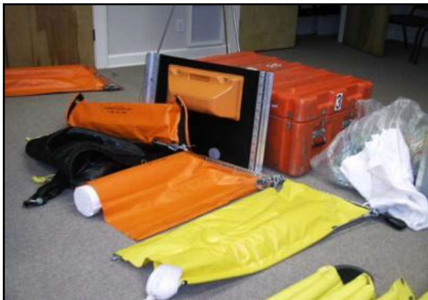
شکل پ. ۴-۱۹ - انواع مختلف بوم‌های تجاری برای استفاده در دریاها و رودخانه‌ها
