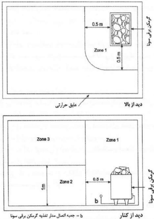
شکل ۱۰-۶-۱۳ طرحواره مناطق (zone) مربوط به سونا بر اساس درجه حرارت محیط آن
