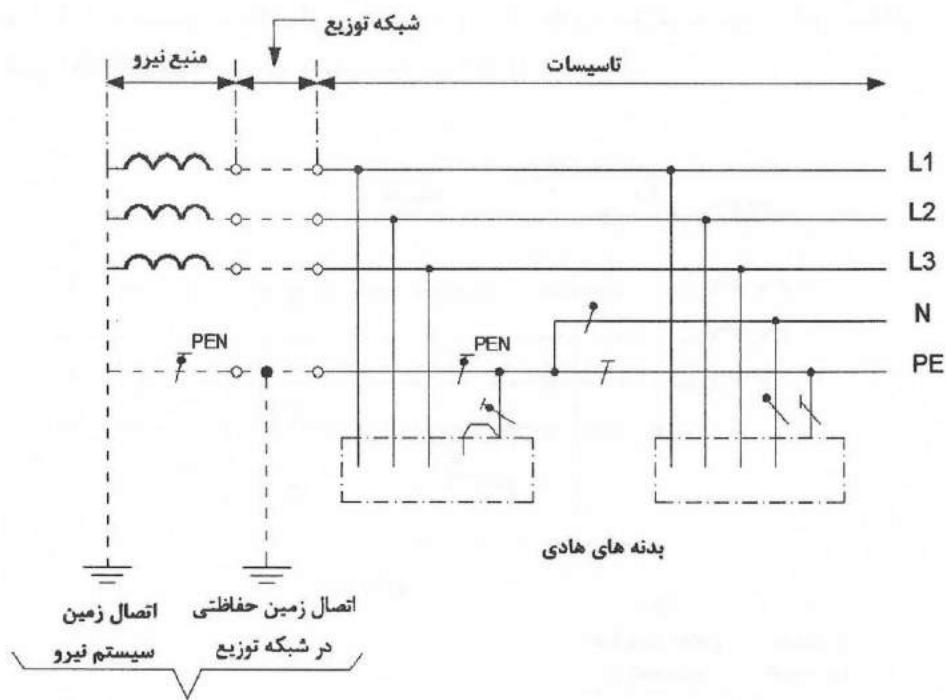
شکل پ ۳:۱-۱ سیستم TN-C-S در سیستم سه فاز چهار سیمه که هادی مشترک حفاظتی -
