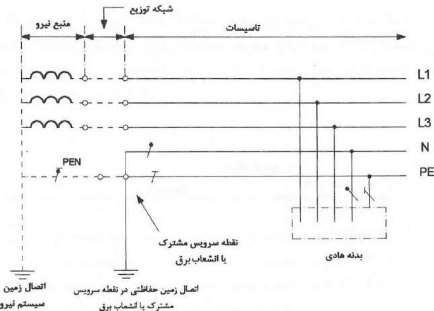
شکل پ-۱-۴: سیستم TN-C-S در سیستم سه فاز چهار سیمه که هادی مشترک حفاظتی - خنثی، در نقطه سرویس مشترک یا انشعباب به هادی حفاظتی و خنثی تفکیک شده است.
