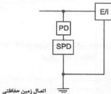
شکل ۱۳-۳-۱۶-۱-۳-۱۶-۱-۳-۱۳ طرحواره نصب وسیله حفاظتی و برقگیر حفاظتی در تابلو برق تغذیه‌کننده دستگاه و یا تجهیزات
