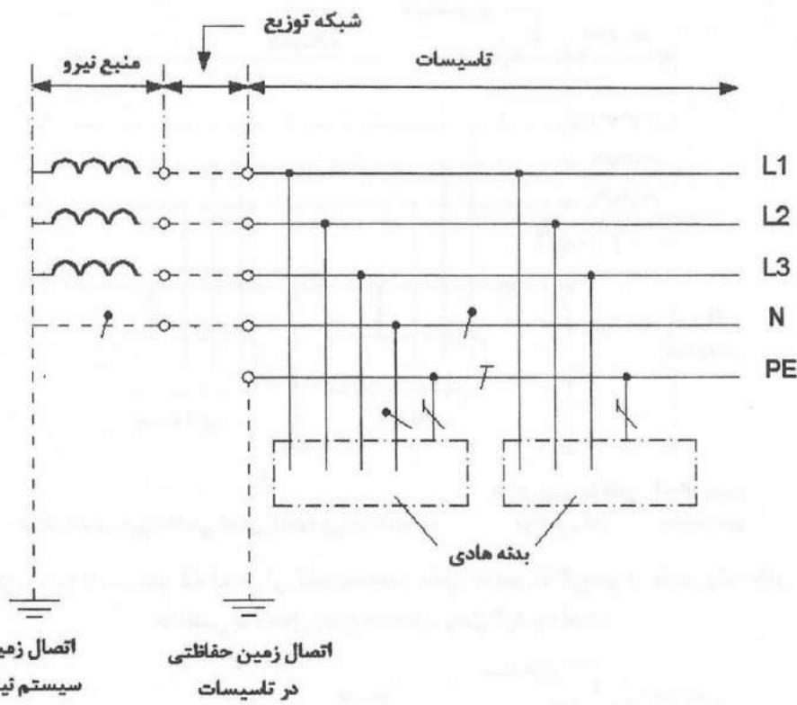
شکل پ-۱-۶: سیستم TT در سیستم سه‌فاز با هادی حفاظتی و با توزیع هادی خنثی در سرتاسر سیستم
