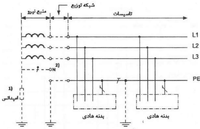
شکل پ-۱-۷: سیستم IT که در آن کلیه بدن‌های هادی به صورت گروهی از طریق یک هادی حفاظتی به اتصال زمین حفاظتی وصل گردیده است.
