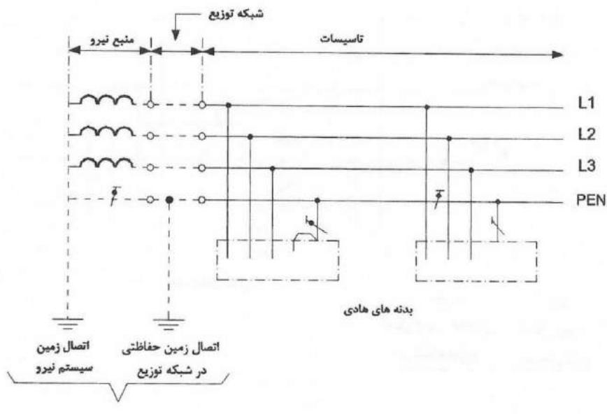
شکل پ-۱-۲: سیستم TN-C در سیستم سه فاز چهار سیمه با هادی مشترک حفاظتی - خنثی در سرتاسر سیستم
