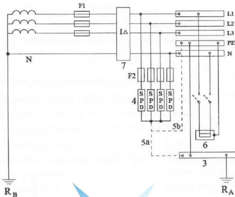
شکل ۱۳-۳-۱۶-۱-۴-۲ طرحواره نصب برقگیر حفاظتی در شبکه توزیع سیستم نیروی TT با قرارگیری برقگیر حفاظتی در طرف تغذیه بار و بعد از کلید حفاظتی جریان باقی‌مانده (RCD) با
