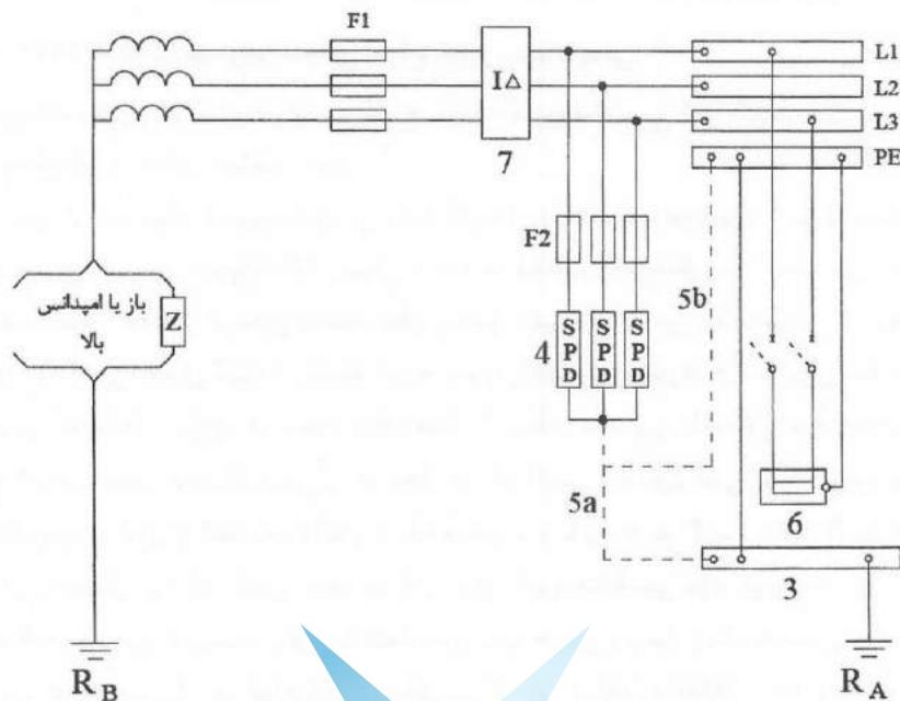
شکل ۱۳-۳-۴-۴: طرحواره نصب برقگیر حفاظتی در شبکه توزیع سیستم نیروی IT
