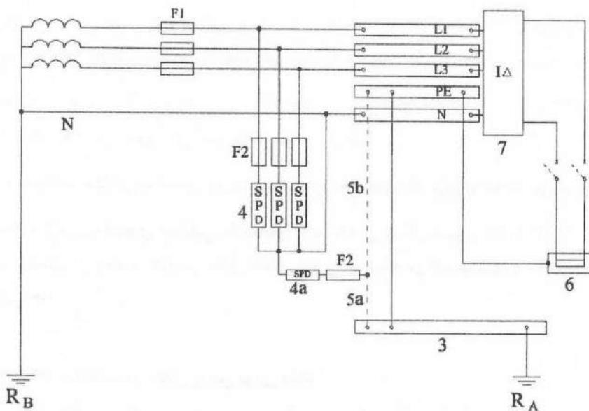
شکل ۱۳-۳-۴: طرحواره نصب برقگیر حفاظتی در شبکه توزیع سیستم نیروی TT با قرارگیری برقگیر حفاظتی قبل از کلید حفاظتی جریان باقیمانده (RCD)
