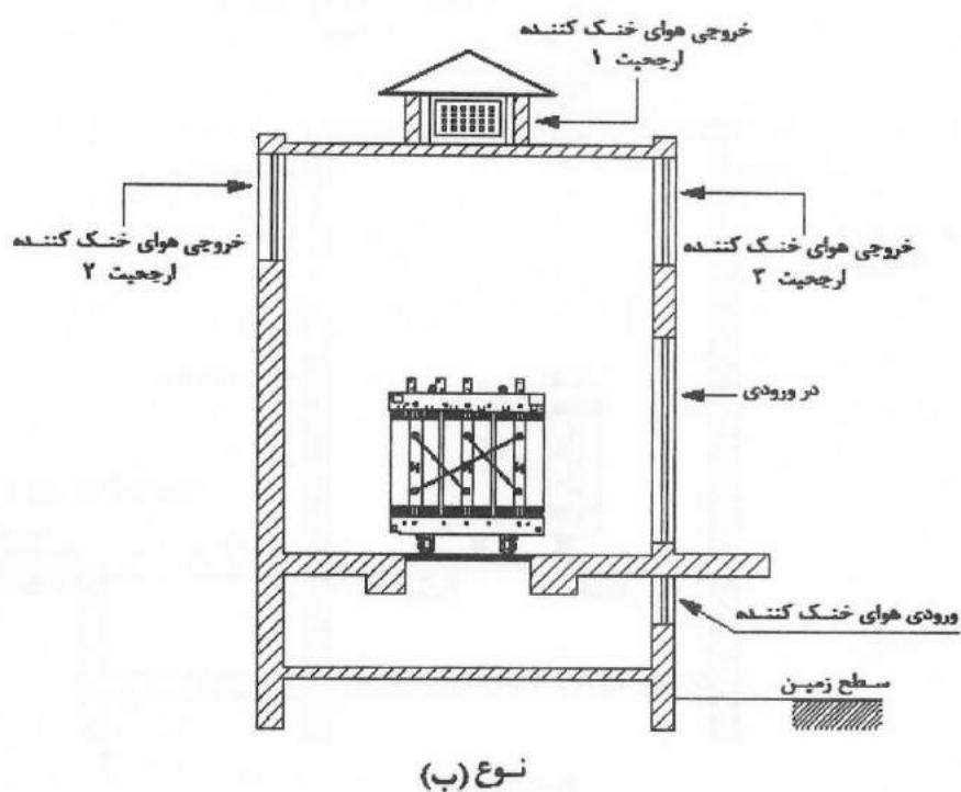
شکل ۱۳-۵-۳-۳:۳ (نوع ب)- طرحواره مقطع قائم اتاق ترانسفورماتور خشک با تهویه طبیعی و بالاتر از سطح زمین
