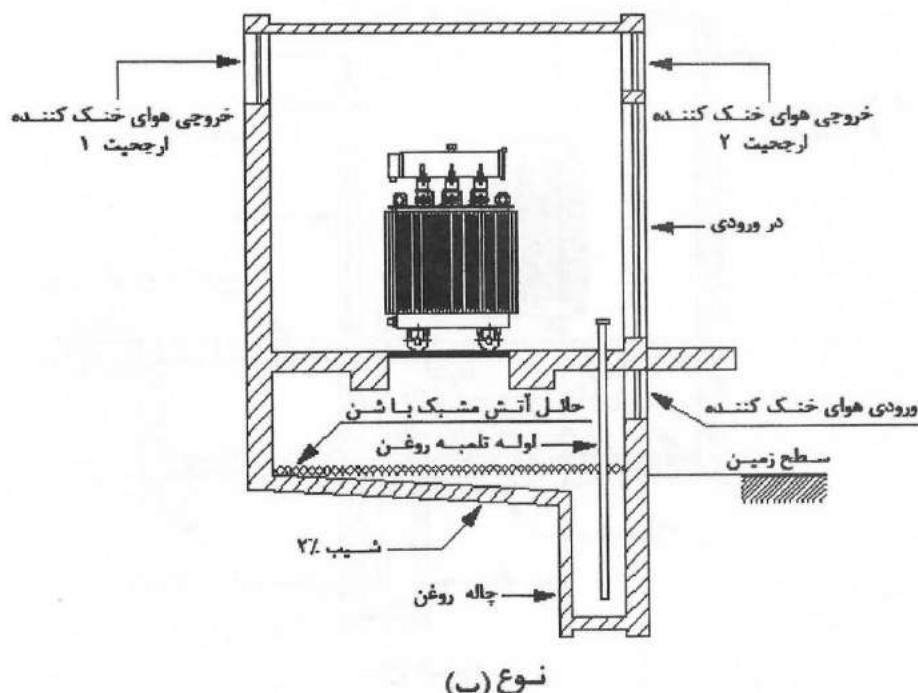
شکل ۱۳-۵-۱۳ (نوع ب)- طرحواره مقطع قائم اتاق ترانسفورماتور روغنی با تهویه مکانیکی و بالاتر از سطح زمین
