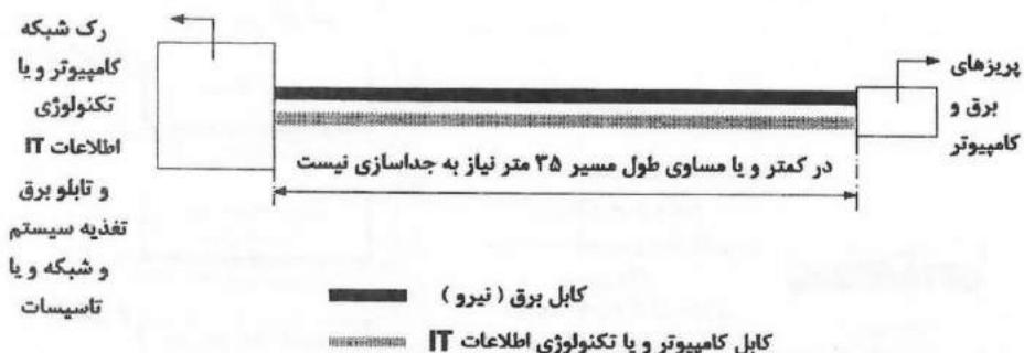
شکل ۳-۱۳-۱: طرحواره مسیر مشترک کابل برق و کابل کامپیوتر یا فناوری اطلاعات IT برای طول مسیر کمتر یا مساوی ۳۵ متر
