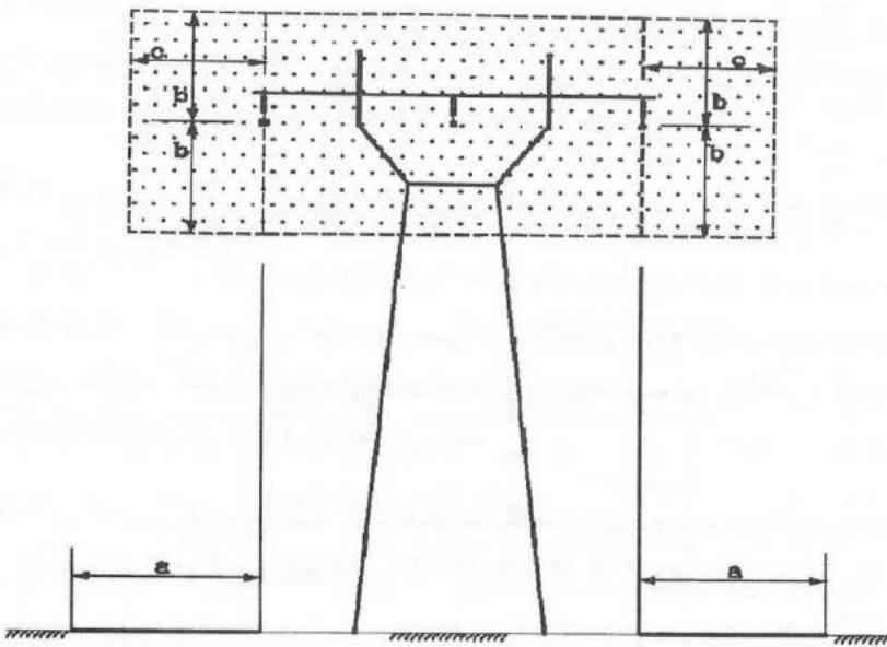
شکل پ ۲-۷-۲: خط هوایی فشار قوی (۶۳ کیلوولت و بالاتر)
