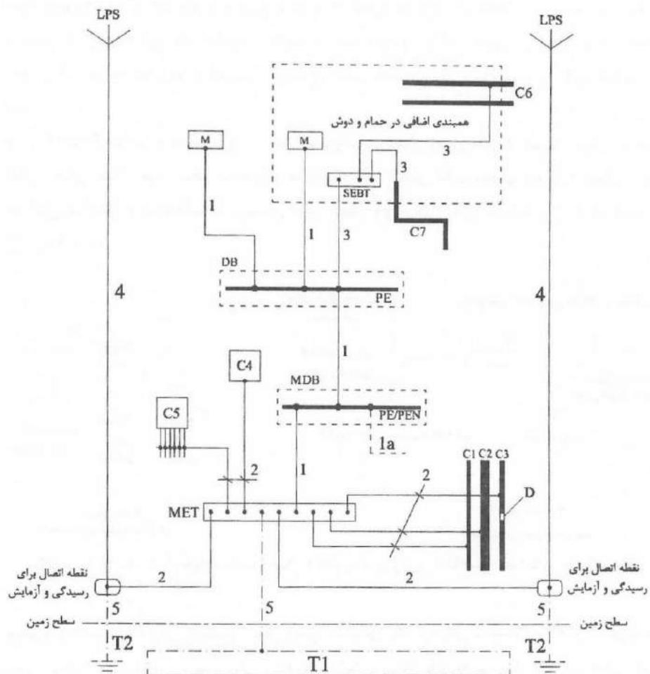
شکل پ ۴-۸-۲-۱ طرحواره عمومی همبندی اصلی و اضافی برای هم ولتاژ کردن
