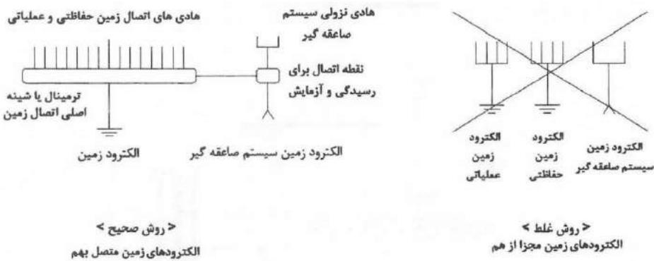
شکل پ ۱-۳-۸-۲ طرحواره نحوه اتصال الکترودهای زمین حفاظتی، عملیاتی و صاعقه‌گیر
