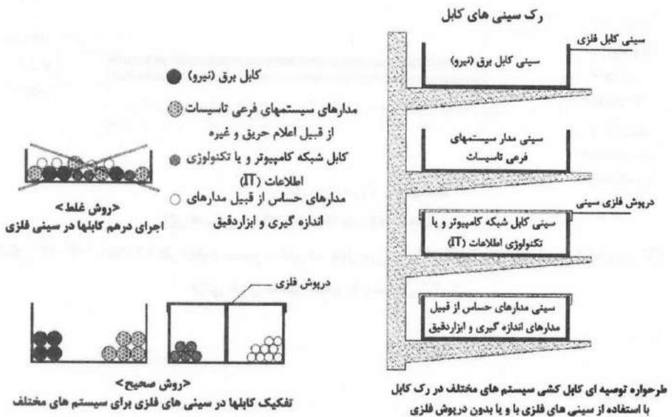
طرحواره توصیه ای کابل کشی سیستم های مختلف در رک کابل با استفاده از سینی های فلزی با و یا بدون دربوش فلزی
