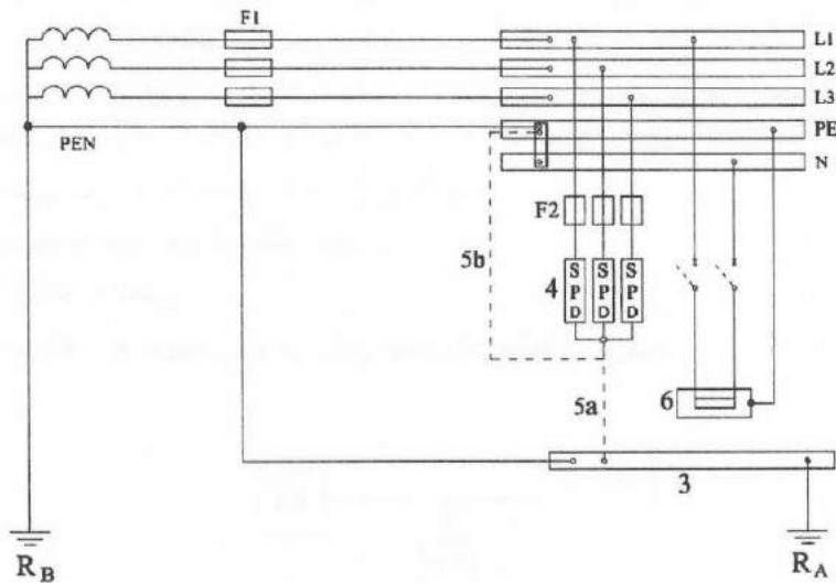
شکل ۱۳-۳-۱۶-۱-۴-۱ طرحواره نصب برقگیر حفاظتی در شبکه توزیع سیستم نیروی TN (سه‌فاز)
